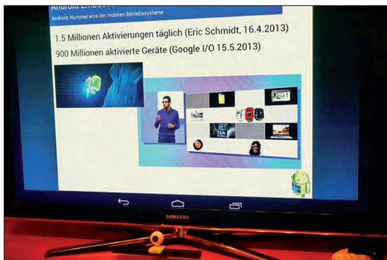
Abb. 3: Nexus 7 per Miracast verbunden (Empfänger unten rechts)
