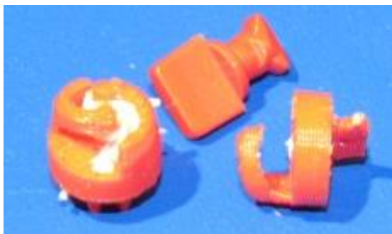
Abb. 7: das ist schief gegangen. Dieser Rast-Kabelclip hat nicht einmal das Herauslösen des Stützmaterials überstanden.
