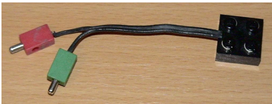
Abb. 8: Technic/RCX-Kabel mit Bananensteckern
