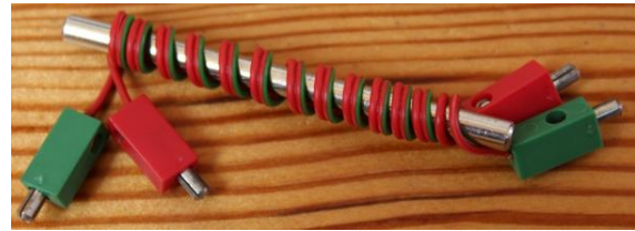
Abb. 8: Erzeugung von „Spiralkabeln“
