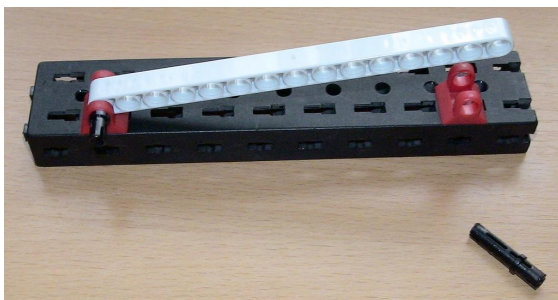
Abb. 1: Mechanische Verbindung der Loch-Balken
