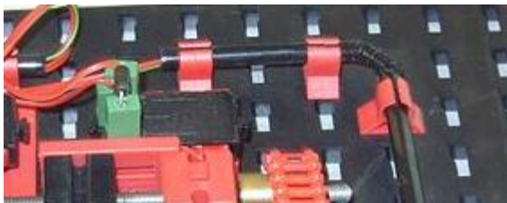
Abb. 9: Trinkhalm als Kabelkanal
