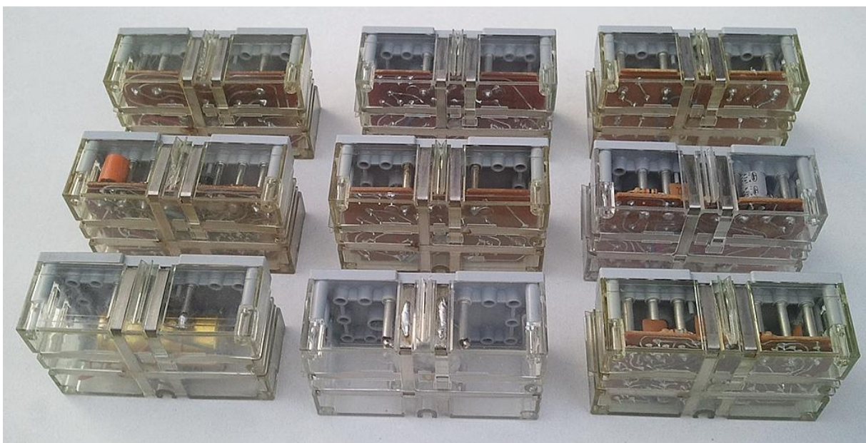
Abb. 16: Rückansicht der Silberlinge mit den handgelöteten Platinen
