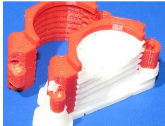
Abb. 6: Eine gedruckte Schleifring-Gehäusehälfte aus Abb. 4, mit und ohne Stützmaterial.
