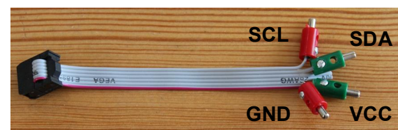
Abb. 3: Belegung des TX-Flachbandkabels
