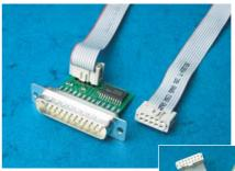
Mit einer Hand voll Bauteilen kann der Parallel-Port des PC das Flash-ROM des Atmel-Prozessors befüllen, ohne dass dieser aus dem B-Modul ausgebaut werden muss.
