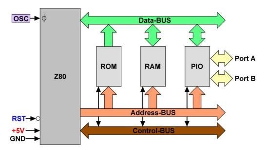
Abbildung 6 - Das grundlegende Bus-System des Z80
