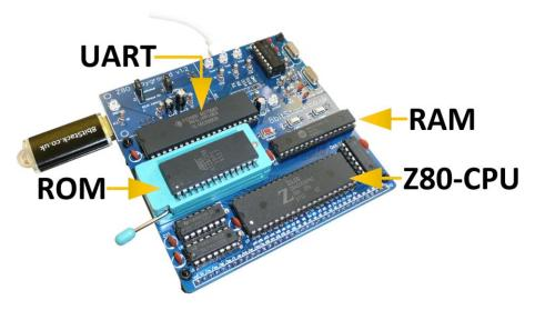
Abbildung 2 - Die grundlegenden integrierten Schaltkreise
