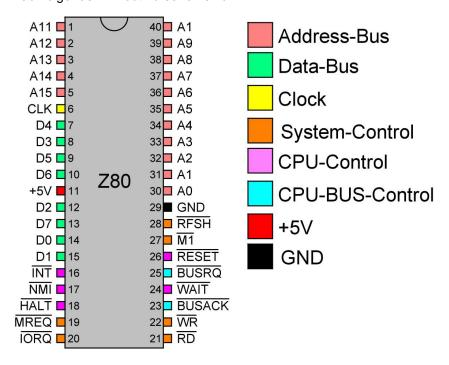
Abbildung 12 - Die Z80-Pinbelegung
