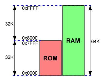
Abbildung 7 - Die Speicheraufteilung von ROM und RAM mit der Überlappung der Bereiche
