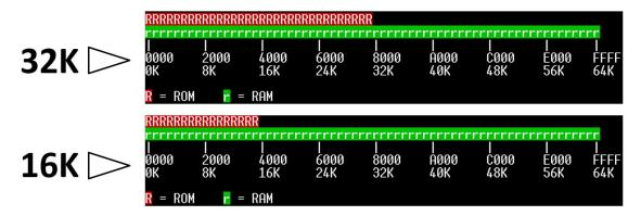
Abbildung 10 - Die Speicheraufteilung bei unterschiedlichen Konfigurationen
