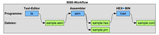
Abbildung 17 - Der Assembler-Workflow für den 8080
