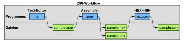
Abbildung 18 - Der Assembler-Workflow für den Z80
