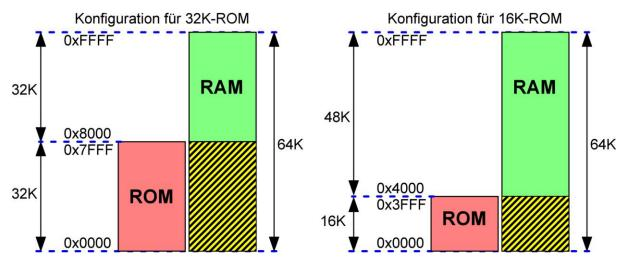
Abbildung 8 - Die Speicheraufteilung bei unterschiedlichen Konfigurationen
