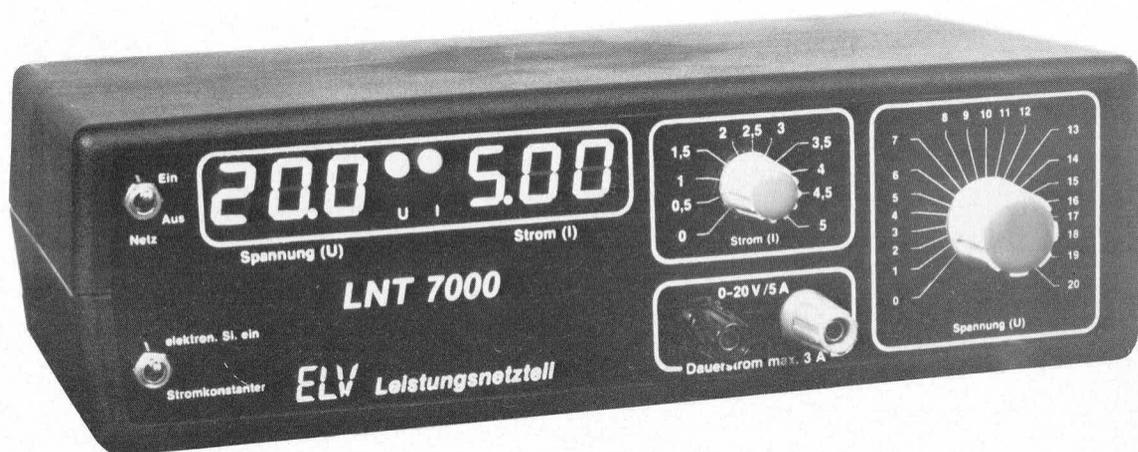
*Mit der Schaltung des hier vorgestellten Leistungsnetzteils LNT 7000 kommen wir dem Wunsch vieler Leser nach einem möglichst großen Ausgangsstrom entgegen. Mit einem Spannungsbereich von 0-20 V bei einem max. Strom von 5 A (Dauerstrom 3 A), dürften die meisten Anwendungsfälle auch bei größerem Strombedarf abgedeckt werden.*
