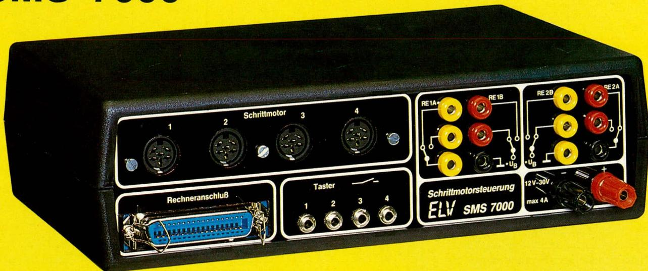
Das ELV-Schrittmotoren-Interface SMS 7000 ermöglicht die gleichzeitige Ansteuerung von vier unabhängigen Schrittmotoren, das Schalten über zwei Hochstromrelais sowie das Abfragen von vier Endschaltern. Der Anschluß dieses universellen Interface erfolgt über die 8-Bit-Parallelschnittstelle eines IBM-PC-XT/AT oder kompatiblen Computers.
