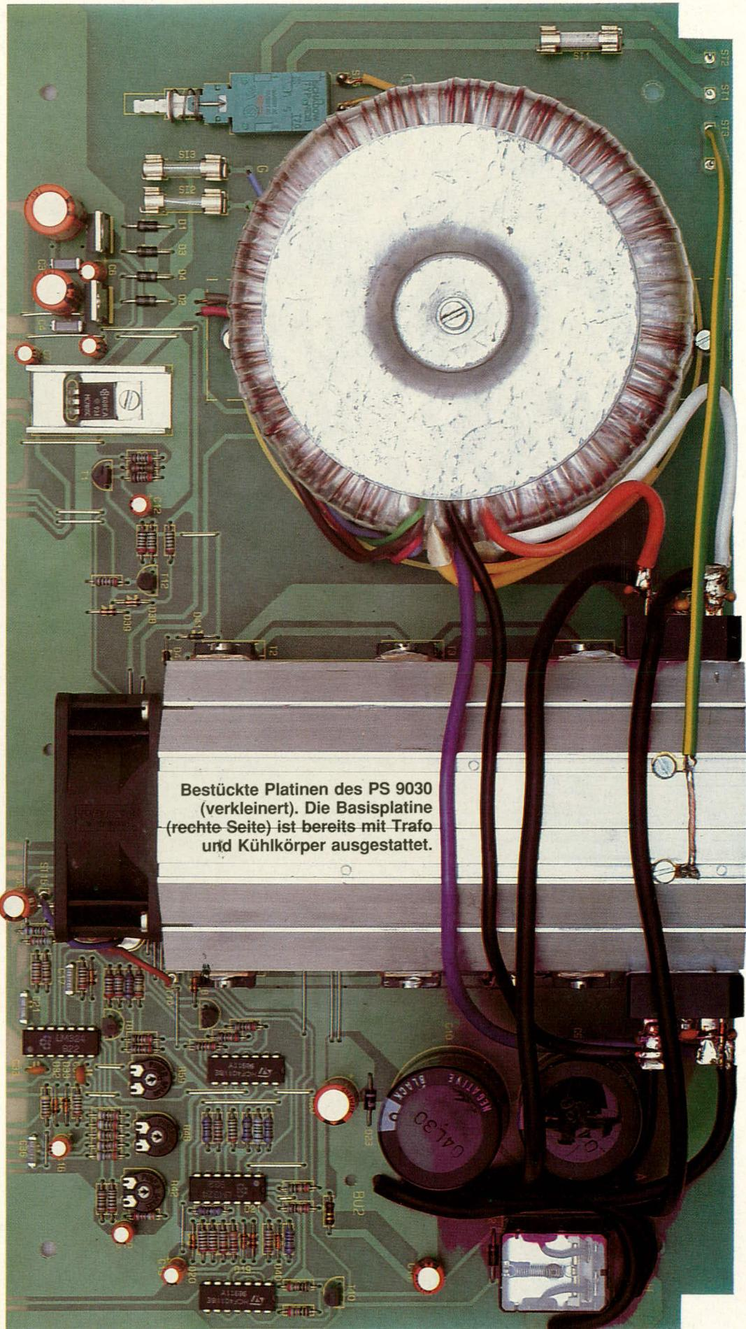
Bestückte Platinen des PS 9030 (verkleinert). Die Basisplatte (rechte Seite) ist bereits mit Trafo und Kühlkörper ausgestattet.
