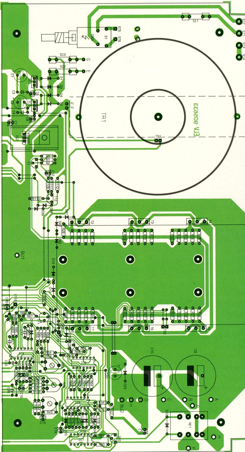
Bestückungspläne des PS 9030. Originalgrößen: Frontplatte (links) 336 x 80 mm, Basisplatte 336 x 184 mm
