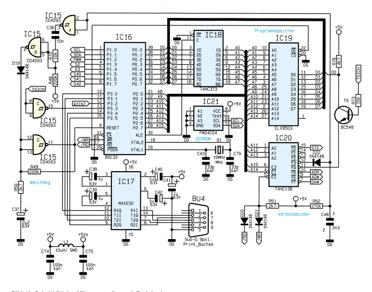
Bild 16: Schaltbild des Mikrocontrollers mit Peripherie
