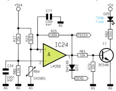
Bild 18: Schaltbild der Endstufen-Temperatursicherung
