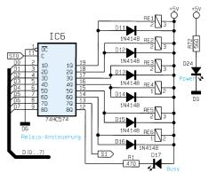
Bild 20: Schaltbild der Relaisansteuerung
