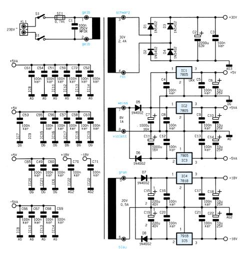
des Digitalteils und der Meßstufe dient. Mit den Dioden D 5 und D 6 ist eine Einweggleichrichtung realisiert, die eine positive und negative Spannung, bezogen auf die Analogmasse, erzeugt. Zur Siebung sind die Kondensatoren C 7 und C 11 vorgesehen. Für die positive und negative 5V-Versorgung der Analogstufen sorgen die Spannungsregler IC 2 (7805) und IC 3 (7905), wobei die Kondensatoren C 8 bis C 10 und C 12 bis C 14 der Unterdrückung von Schwingneigungen dienen.
