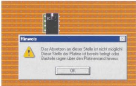
**Bild 5:** Das versehentliche Mehrfachbelegen von Lötunkten ist nicht möglich.
