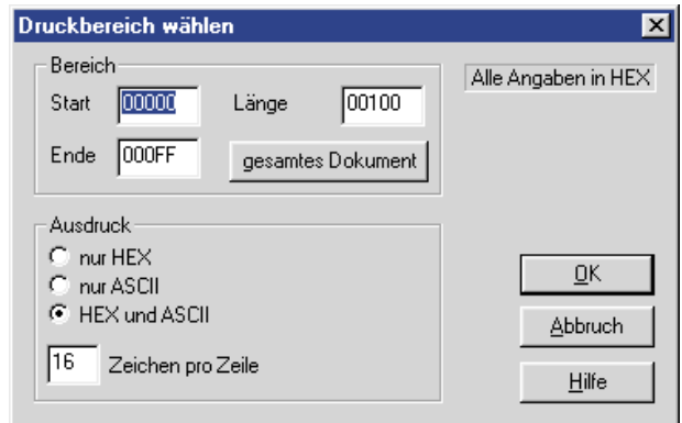
Bild 12: Will man einen bestimmten Bereich des Puffers ausdrucken, ist dieser im Druckmenü komfortabel auswählbar.
