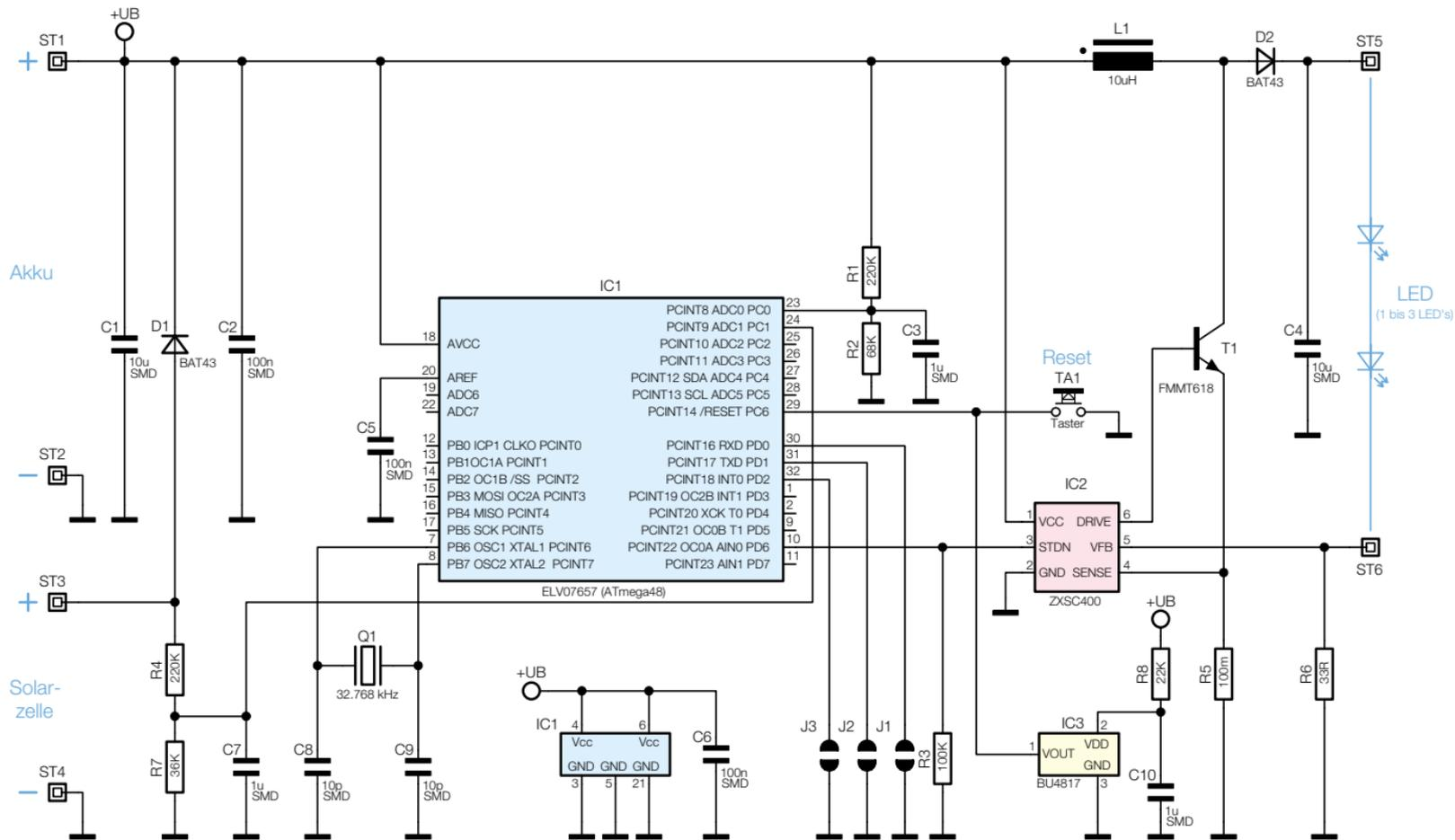
**Bild 3: Das Schaltbild der intelligenten Solarleuchtensteuerung**
