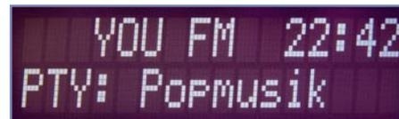
**Bild 23: Die Programm-Typus-Anzeige**
