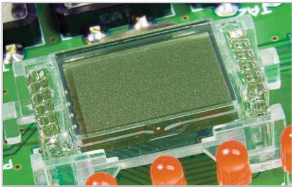
Bild 9: Halterahmen des Displays mit montiertem Display
