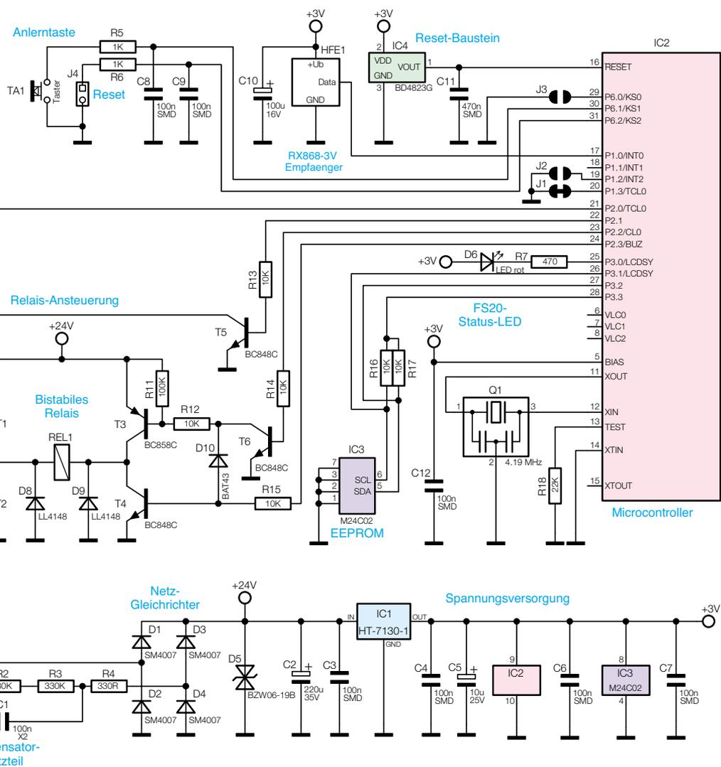
Bild 6: Das Schaltbild des Funk-Wechselschalters FS20 WS1
