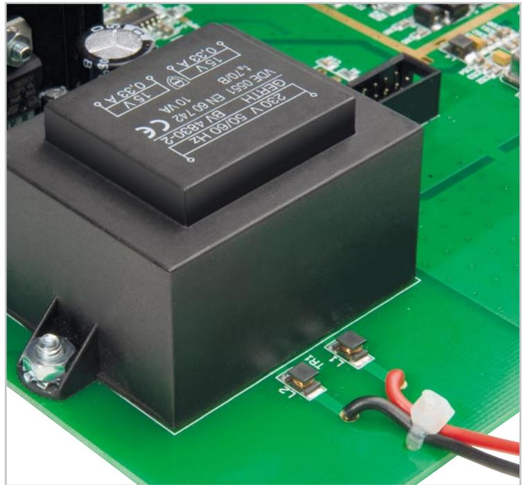
Bild 9: Detailbild zum Einbau der primärseitigen Zuleitungen des Netztransformators
