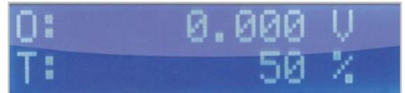
Erst nach dem Wechsel von der Einstellungsanzeige in die Übersichtsanzeige werden die geänderten Parameter im EEPROM des Mikrocontrollers gespeichert. Durch diese Methode wird der Speicherzugriff auf das EEPROM deutlich minimiert. Das EEPROM stellt dann die gespeicherten Einstellungen beim Start wieder bereit.
