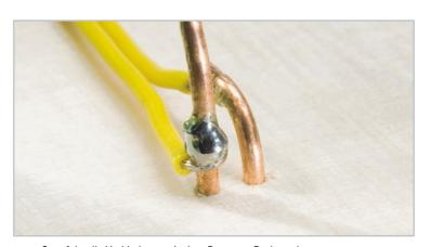
**Bild 5**: So erfolgt die Verbindung zwischen Parcours-Draht und Anschlussleitungen.
