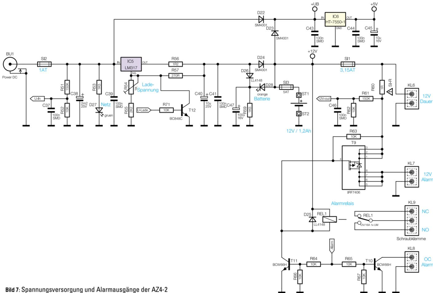
Bild 7: Spannungsversorgung und Alarmausgänge der AZ4-2
