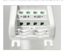
Bild 2: Die Anschlüsse werden mit einem Aufkleber gekennzeichnet.
