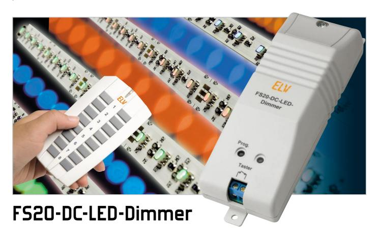
Dieser Dimmer ist speziell für LEDs bzw. LED-Stripes mit einer Versorgungsspannung von 12 V ausgelegt. Die Betriebsspannung wird dabei extern zugeführt. Die Bedienung erfolgt über FS20-Fernbedienungen, zusätzlich ist eine Bedienung/Einstellung direkt am Gerät und über einen externen Taster möglich. Durch den Einsatz von MOSFET-Technik ist ein relativ hoher Ausgangsstrom von bis zu 5 A möglich, was einer Ausgangsleistung von 60 Watt entspricht.
