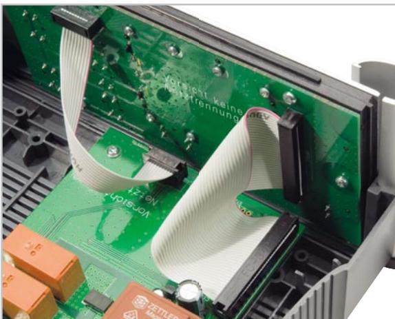
Bild 29: Anschluss der Flachbandleitungen an die Basisplatine
