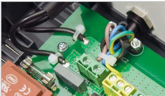
Bild 19: Anschluss und Sicherung der Netzanschlussleitung
