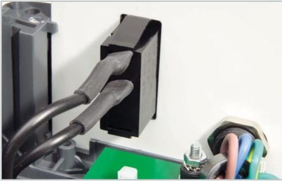
Bild 21: Montage des Ein-/Ausschalters in die Gehäuse-Rückwand
