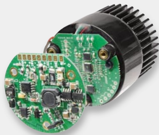
Bild 8: So wird die LED-Steuerplatine an den Nuventix-Kühler montiert.
