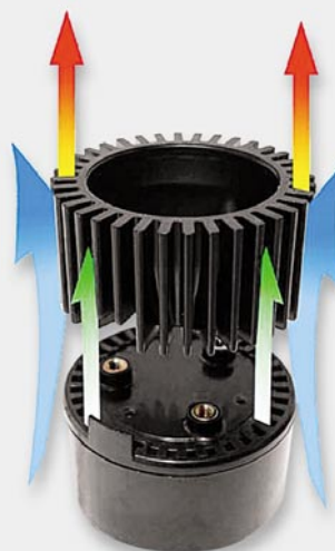
Bild 2: Das Funktionsprinzip des Synjet-Kühlers. Der Membranantrieb befördert die Kühlluft so, dass sie zielgerichtet durch die Kühlrippen streicht.
