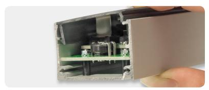
Bild 17: Einsetzen der Frontplatte
