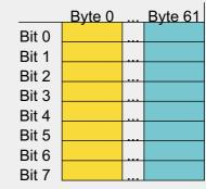
Bild 13: Die Zuordnung der 62 Parameter-Bytes zu den Displaysegmenten
