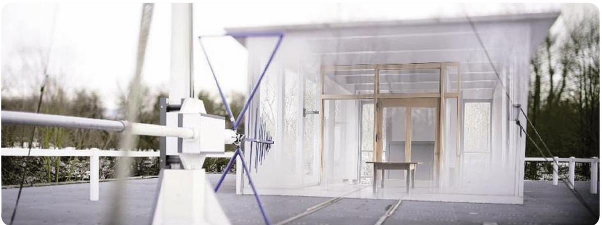
Bild 3: Freifeldmessplatz der Fa. Phoenix Testlab mit Wetterschutz
