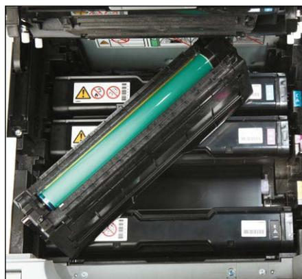
**Die meisten Hersteller setzen inzwischen Toner ein, bei denen die Bildtrommel integriert ist, so wie hier beim Ricoh zu sehen ist. Mit Toner kommt man damit kaum in Kontakt.**
