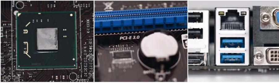
Der neue Z77-Chipsatz besteht wieder aus nur einem Chip. Im Vergleich hat er nun einen USB-3.0-Controller integriert. Mit der nächsten Intel-CPU kommt auch PCI Express 3.0.
