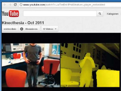
Je heller die Flächen, desto näher ist das Objekt: Kinecthesia, der Gürtel für Blinde, hilft bei der Orientierung.
