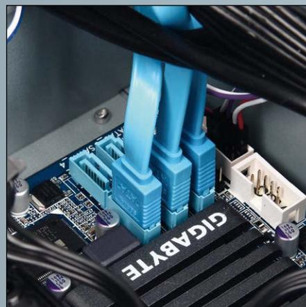
In dem Antec-Gehäuse können nur Mainboards eingesetzt werden, bei denen die SATA-Kabel von oben eingesteckt werden.
