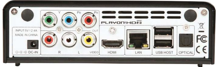
Analoge Audio- und Video-Anschlüsse haben inzwischen nur mehr eine untergeordnete Bedeutung. Wichtiger sind die digitalen Anschlüsse.
