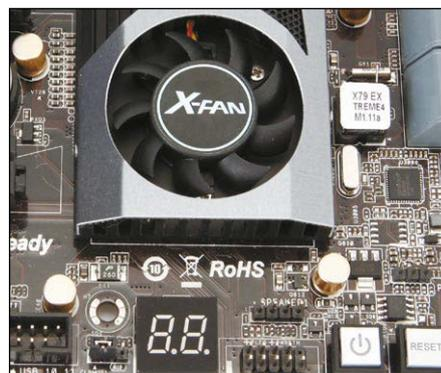
**Der Chipsatzlüfter auf dem Asrock-Board läuft nur bei höheren Chiptemperaturen an. Sie können im BIOS konfiguriert werden.**
