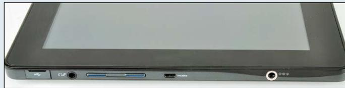
Das Samsung Slate ist 13 Millimeter flach. An Schnittstellen sind Micro-HDMI und ein USB-Port vorhanden.
