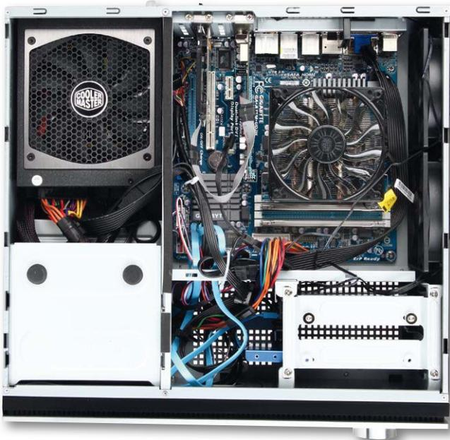
Das Innenleben unseres Eigebau-HTPC: Das Fusion-Remote-Gehäuse von Antec ist in drei Zonen aufgeteilt, die eine optimale Kühlung ermöglichen. Die beiden 120-mm-Lüfter neben dem Mainboard laufen mit minimaler Drehzahl. Der große Lüfter des Cooler-Master-Netzteils läuft im Normalbetrieb gar nicht an. Daher läuft der PC sehr leise, das ist entscheidend für einen Wohnzimmer-Rechner.
