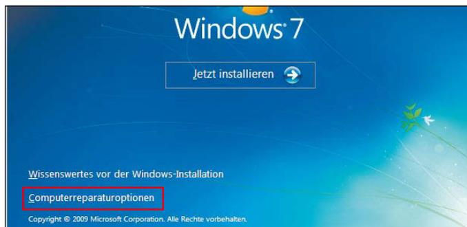
Der erste entscheidende Schritt beim Angriff: Nach dem Start von der DVD wird nicht das Windows-System installiert, sondern der Angreifer wählt die *Computerreparaturoptionen* aus.
