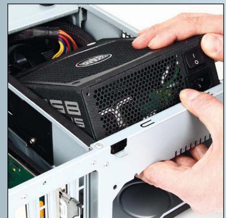
Große Netzteile wie das Cooler Master Silent Pro Hybrid lassen sich erst nach dem Einbau des optischen Laufwerks montieren.
