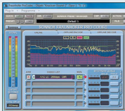
Der Sonnox Fraunhofer Pro-Codec ermöglicht das Vorhören in Echtzeit, um den Sound in verschiedenen Komprimierungen zu testen.
