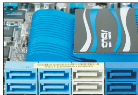
Festplatten und optische Laufwerke werden inzwischen ausschließlich über eine schnelle SATA-Schnittstelle angebunden.
