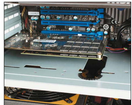
Das superschnelle RevoDrive3 X2 mit 240 GByte Flash-Speicher dient als Systemlaufwerk.
