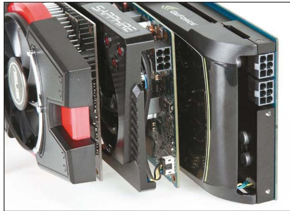
Die Zahl der Stromanschlüsse auf den Karten reflektiert deren Leistungsaufnahme: Die ASUS-Karte mit GeForce GT 640 kommt ohne zusätzliche 12-Volt-Versorgung aus, die AMD-Karten begnügen sich mit einem Anschluss, der GeForce GTX 560 Ti benötigt zwei.
