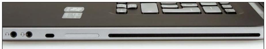
Im Gegensatz zum Apple hat der XPS 15 von Dell noch ein optisches Laufwerk eingebaut. Als Auswurfknopf für das Slot-in-Drive dient eine der Funktionstasten im Keyboard.
