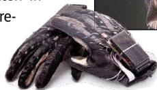
Enable Talk: Sensorhandschuhe erfassen Gebärdensprache, die von einem Smartphone übersetzt wird.
