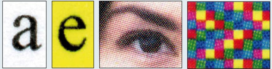
Bei Bürodokumenten macht dem Laserdrucker keiner was vor. Die Schärfe der Schrift und Homogenität des Tonerauftrags sind hervorragend. Auch die Grafikdarstellung ist sehr präzise. Beim Fotodruck stößt das Rasterdruckverfahren an seine Grenzen.
