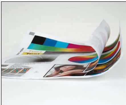
**Flüssiges Gel:** Das Gel von Ricoh ist so flüssig, dass sich vollflächige Grafikausdrucke auf Normalpapier nach der Trocknungsphase aufrollen.
