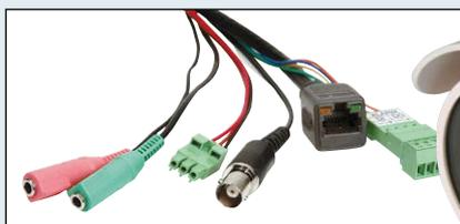
Kabelsalat von links nach rechts: Audio-Eingang und -Ausgang, Stromversorgung, BNC, RJ-45 LAN und Alarm I/O.
