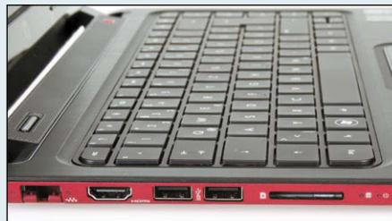
Mit seinem Intel-H77-Chipsatz verfügt der HP Envy 4 automatisch über USB-3.0-Schnittstellen. Ein GBit-LAN-Port ist auch vorhanden.
