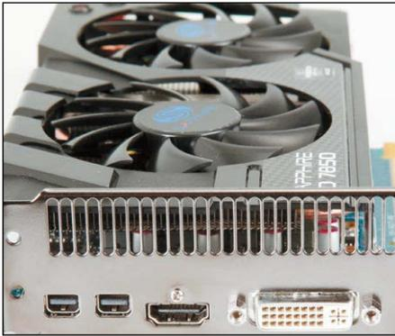
**AMD-Karten wie der Testsieger Sapphire HD 7850 OC 2GB erlauben Multimonitor-Betrieb mit bis zu vier Displays.**
