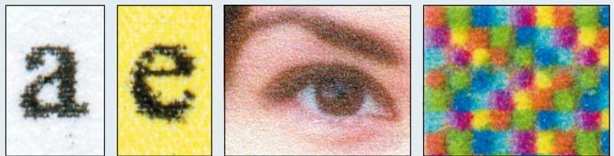
Erstaunlich: das Gel des Ricoh ist überaus flüssig, was sich auch im minimalen Auslaufen der Schrift bemerkbar macht. Die kleinen Kästchen leiden unter der schnellen Druckgeschwindigkeit. Das Auge ist präzise, aber insgesamt zu hell.
