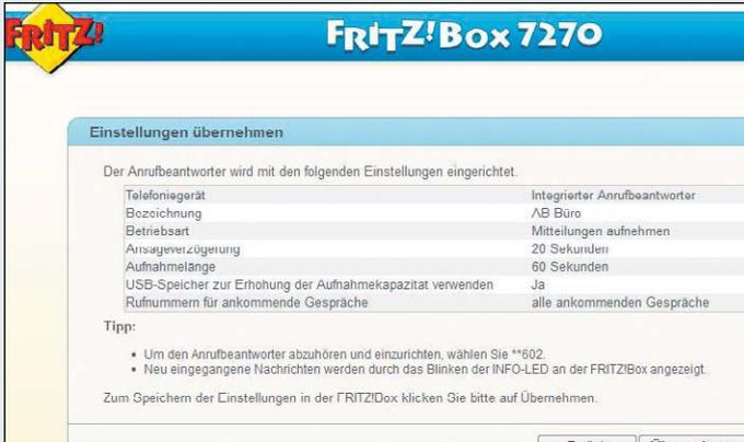
Die Standard-Konfiguration eines AB-Gerätes in der Fritz!Box. Insgesamt stellt der Router bis zu fünf unabhängige Anrufbeantworter bereit.
