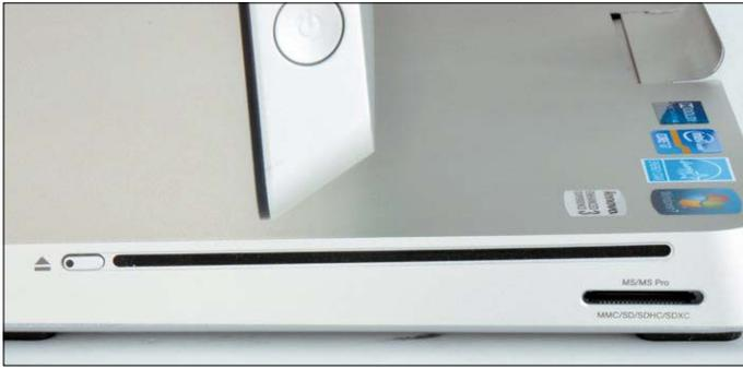
Der IdeaCentre A720 verfügt über einen DVD-Brenner in Form eines Slot-in-Laufwerks. Zudem besitzt der Rechner einen Kartenleser.
