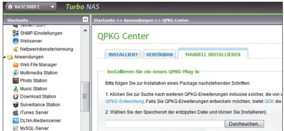
Apps aus dem Web lassen sich manuell auf die NAS installieren. Laden Sie die Dateien auf den PC und wählen Sie „manuelle Installation“ (hier Qnap).
