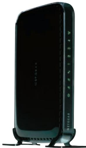
**Dualband-Technik:** Der Netgear WN2500RP ist sowohl im 2,4- wie auch im 5-GHz-Band zuhause. Das bietet mehr Alternativen bei der Übertragung.
