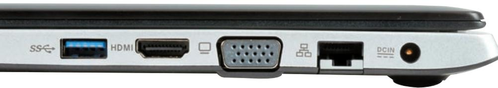
Trotz der flachen Bauform hat Sony beim VAIO T-Serie 15 die LAN- und die VGA-Buchse im Gehäuse untergebracht. Ein Adapter wie beim Acer ist hier nicht notwendig.
