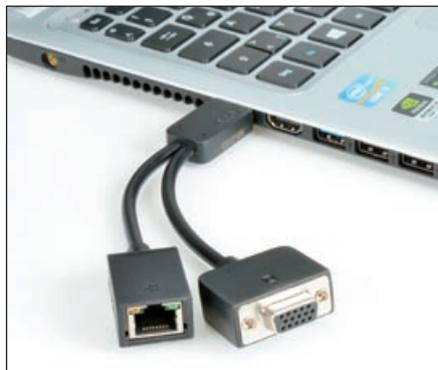
Der LAN- und der VGA-Anschluss werden beim Acer Aspire über ein Y-Kabel mit einem Acer-spezifischen Stecker nach außen geführt.
