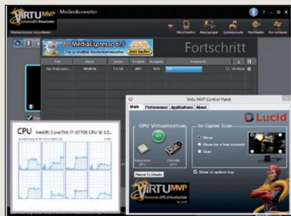
Mit Lucid Virtu MVP kann man bei geeigneten Mainboards die Intel-GPU parallel zu einer externen Grafikkarte für das Codieren nutzen.
