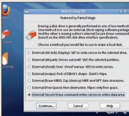
**Disk Erase kann den laufwerksinternen sicheren Löschbefehl SEU auslösen.**
