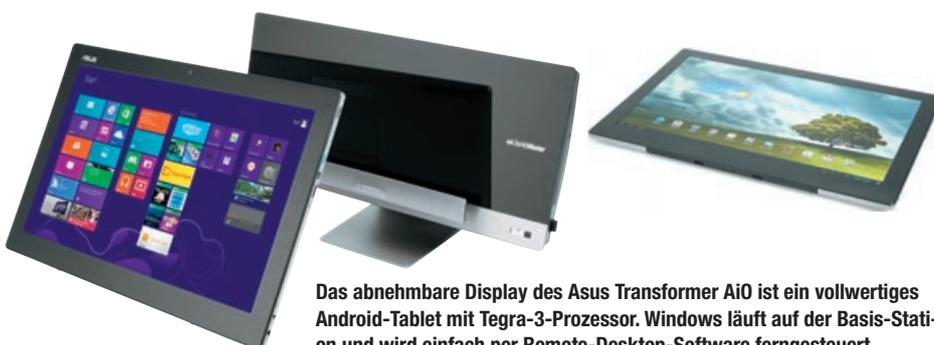
Das abnehmbare Display des Asus Transformer AiO ist ein vollwertiges Android-Tablet mit Tegra-3-Prozessor. Windows läuft auf der Basis-Station und wird einfach per Remote-Desktop-Software ferngesteuert.
