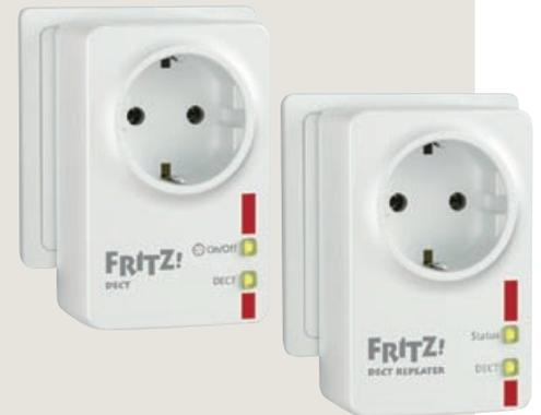
Gerätestuerung per DECT: Die FritzDect 200 stecken Sie in eine Steckdose. Die Steuer-Signale kommen über die Fritzbox.
