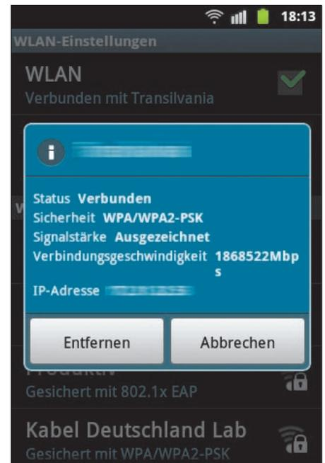
Probleme mit WLAN-Netzen können Sie lösen, indem Sie die Netzwerkinformationen mit *Entfernen* löschen und sich danach neu einwählen.
