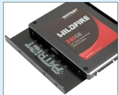
4 Beim Einbau in den Desktop-PC verwendet man einen Einbaurahmen für den Laufwerksschacht.
