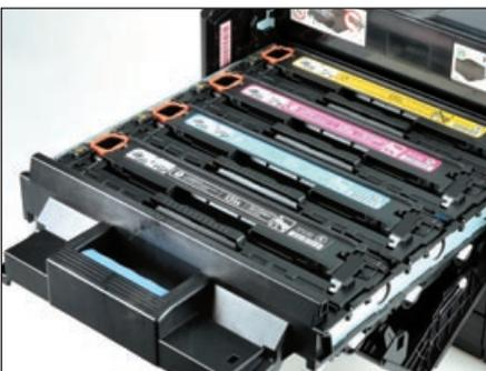
Der Toner des HP Laserjets Pro 200 M251n sitzt leicht händelbar in einem ausziehbaren Schlitten.
