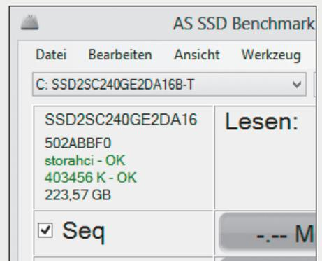
Alles korrekt: Die obere, grün markierte Zeile im Tool *AS SSD* zeigt, dass AHCI eingeschaltet ist, die grüne Zeile darunter, dass auch das Alignment stimmt.
