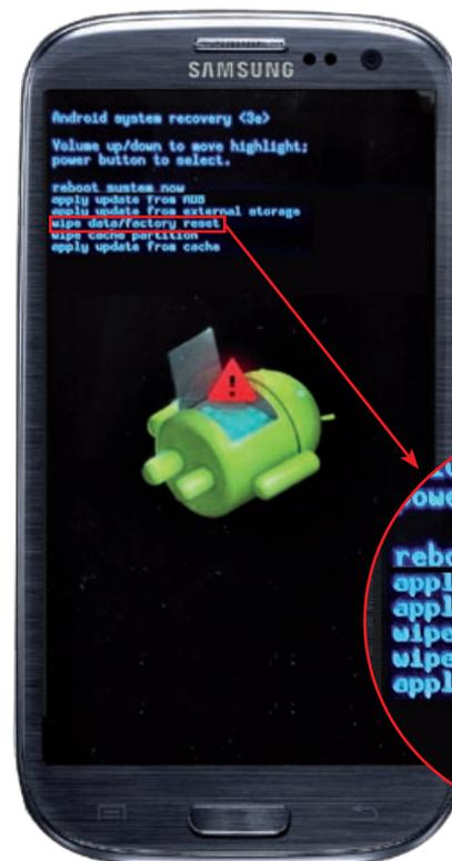
Wenn wirklich nichts mehr geht: Mit einer Tastenkombination bootet das Samsung Galaxy SIII in den Recovery-Modus. Dort sorgt die Funktion *wipe data/factory reset* für die Zurücksetzung in den Werkszustand.
