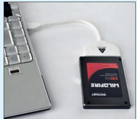
2 Beim Notebook schließen Sie die SSD über einen USB-Adapter oder ein USB-Gehäuse an.
