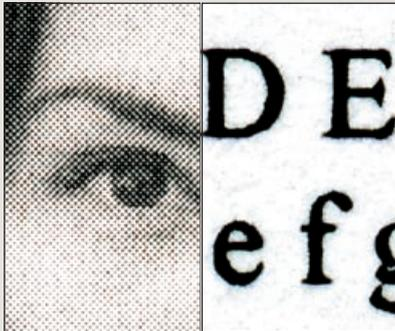
HP LaserJet Pro P1102w: Sehr starker Toner-auftrag, gute Graustufung bei Bildern.
