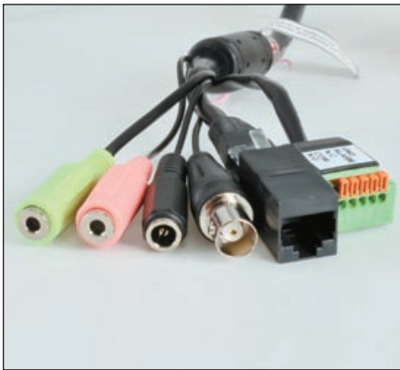
IP-Kamera-Kabelsalat von links nach rechts: Audio-Ausgang, Audio-Eingang, Stromversorgung, BNC, RJ-45 LAN und Alarm I/O.
