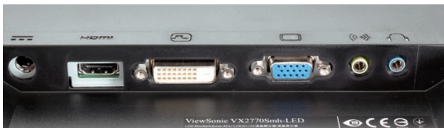
Viewsonics VX2770Smh-LED hat mit HDMI, DVI, VGA, Audio-In sowie Audio-Out (v.l.n.r.) fast alle gängigen Schnittstellen zu bieten – lediglich ein DisplayPort fehlt.
