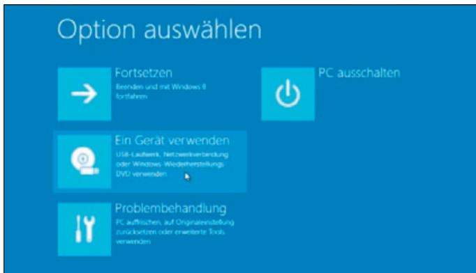
Windows 8: Per Shift-Click auf Herunterfahren landen Sie in einem Menü, das Zugriff auf vom UEFI ans Betriebssystem übermittelte Schnittstellen bietet: Hier wählen Sie eine der im UEFI hinterlegten Boot-Optionen als nächsten Standard.
