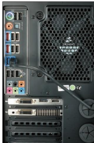
Links: Das AMD-System ist sogar mit einer WLAN-Karte und einem zusätzlichen USB-3.0-Controller bestückt. An der Asus-Grafikkarte können bis zu sechs Monitore gleichzeitig angeschlossen werden.
