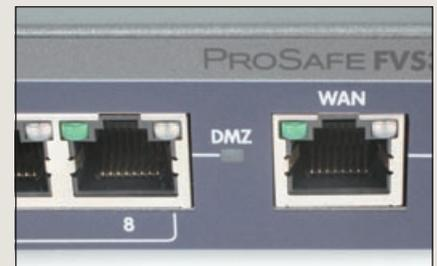
Moderne Firewalls verfügen über einen eigenen DMZ-Bereich, der vom lokalen Netz physikalisch abgetrennt ist.
