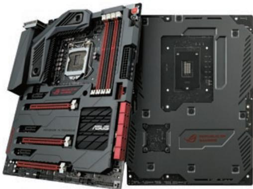
Mit der CrossChill-Kühlung kann das Asus-Mainboard Maximus VI Formula sowohl mit Luft- als auch mit Wasser gekühlt werden.
