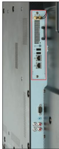
Der eigentliche Rechner steckt als Modul in einem 19-Zoll-Einschub und kann so getauscht werden.
