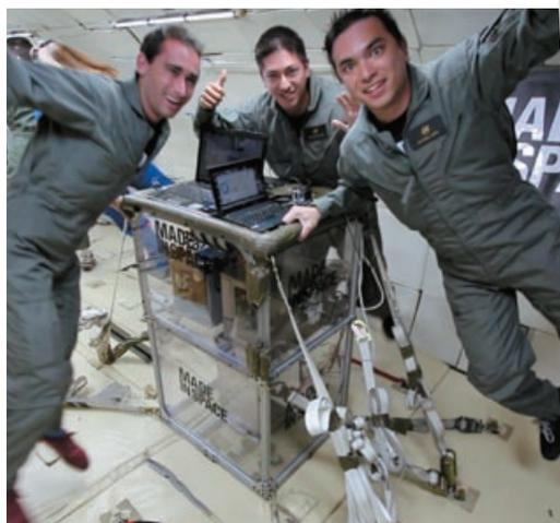
3D-Drucker im schwerelosen Test: Im Parabelflug wird das Gerät auf Herz und Nieren geprüft.
