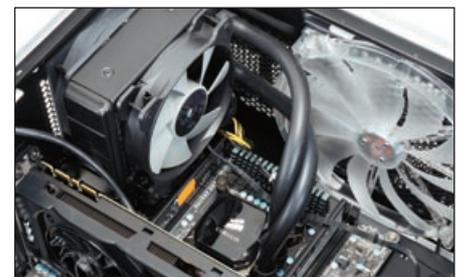
Sowohl der hier abgebildete Intel-Prozessor als auch die AMD-CPU werden durch eine Corsair-Wasserkühlung auf niedriger Temperatur gehalten.
