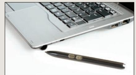
Die Stiftspitze beim N-Trig-Stift im Lieferumfang des Fujitsu Stylistic erkennt 256 Druckstufen, Wacom-Stifte erkennen sogar 1024 Stufen.
