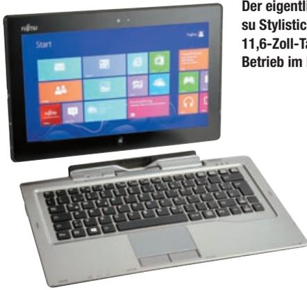
Der eigentliche Rechner sitzt beim Fujitsu Stylistic Q702 hinter dem Display, das 11,6-Zoll-Tablet wird für den Notebook-Betrieb im Dock eingesteckt.
