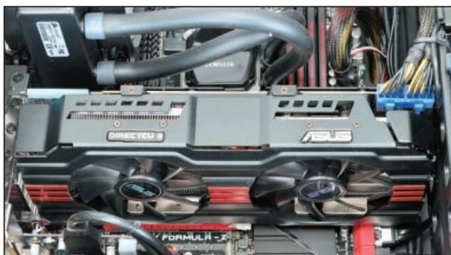
Die Asus-Grafikkarte im AMD-System belegt gleich drei Slots im Gehäuse. Der AMD Radeon HD 7970 kann hier auf drei GByte GDDR5 als Grafikspeicher zugreifen.
