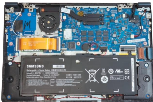
Lithium-Polymer-Akkus (unten) machen durch ihr fehlendes Gehäuse den Bau sehr flacher Notebooks mit trotzdem guter Akkulaufzeit erst möglich.
