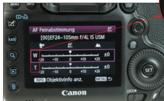
**Die Canon 5D Mark III erlaubt die Feinjustierung der Schärfe für den Tele- und den Weitwinkelbereich eines Objektivs.**
