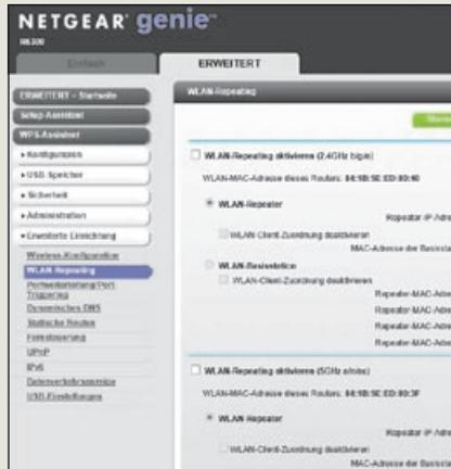
Die Repeater-Funktion bei unserem Netgear R6300-Testrouter.
