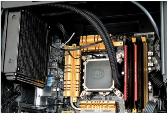
Die Seidon-120-V-Wasserkühlung auf dem Core-i7-4770K-Prozessor ist ein geschlossenes System und daher wartungsfrei.
