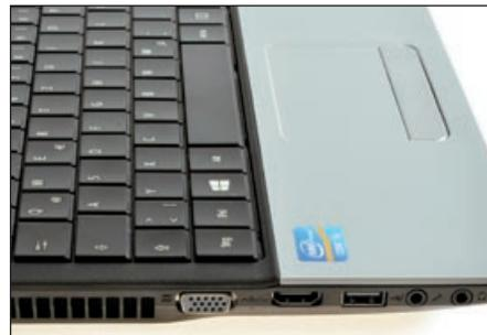
Der Acer TravelMate P253-M verfügt neben dem HDMI-Ausgang noch über eine VGA-Buchse.
