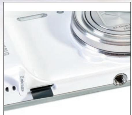
Beim Galaxy S4 zoom befinden sich Micro-SD-Anschluss und Stativgewinde am Gehäuserand.
