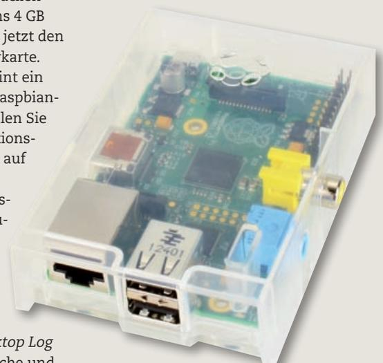
Der kleine Raspberry Pi ist ein vollwertiger Linux-PC mit 512 MByte Hauptspeicher.
