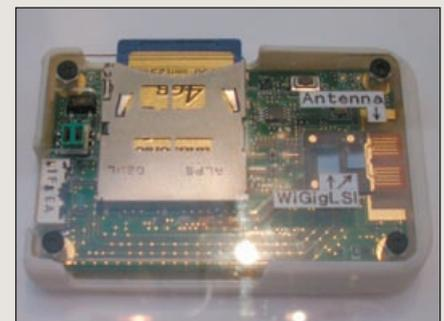
Ein Panasonic-Prototyp fotografiert auf dem IDF: Rechts sind der WiGig-Chipsatz (Transceiver und Baseband) und das Antennen-Array zu sehen.
