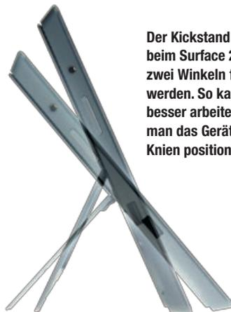
Der Kickstand kann beim Surface 2 Pro in zwei Winkeln fixiert werden. So kann man besser arbeiten, wenn man das Gerät auf den Knien positioniert hat.
