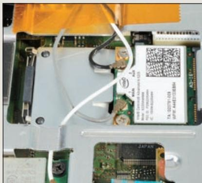
Mini-PCI-E-Karten mit halber Höhe benötigen einen Adapter für den Einbau in ältere Notebooks.
