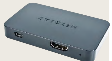
Der Netgear Push2TV unterstützt Miracast und Intel WiDi. Er diente uns auch als Testgerät.
