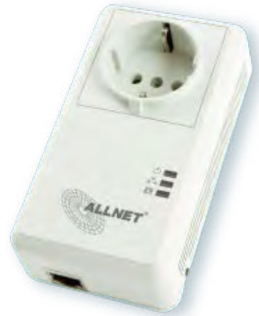
Mit Ethernet-Steckdosen können alle elektrischen Geräte per PC ein- und ausgeschaltet werden.
