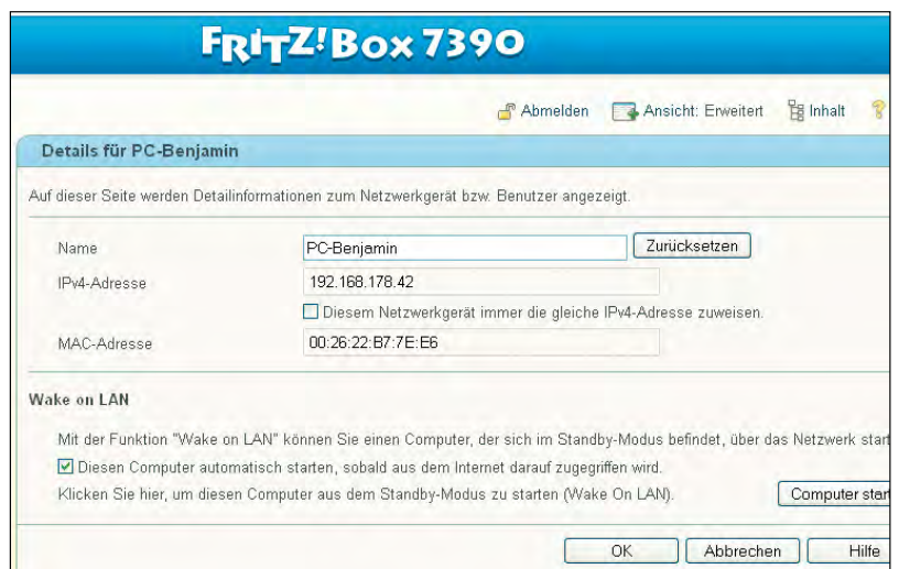
Die Fritzbox sorgt dafür, dass ein PC sogar über das Internet automatisch erwacht.
