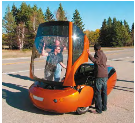
Urbee, das erste Auto aus dem 3D-Drucker, wurde von Kor EcoLogig gebaut. Ein Jahr später folgte ein Flugzeug, das Ingenieure der Universität Southampton entwickelten.
