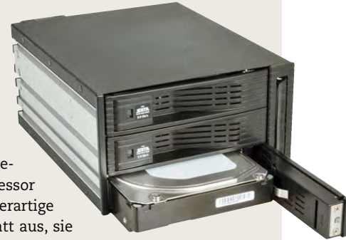
Der SATA-Wechselrahmen von Sharkoon für drei HDDs beansprucht zwei 5,25-Zoll-Einschübe.
