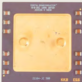
Die RISC-CPU DEC Alpha lieferte 1997 eine Taktrate von bis zu 533 MHz.
