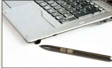
Die Stiftspitze beim N-Trig-Stift im Lieferumfang des Fujitsu Stylistic erkennt 256 Druckstufen, Wacom-Stifte erkennen sogar 1024 Stufen.
