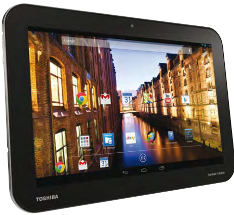
Das Toshiba Excite Pro ist eines der ersten Android-Tablets mit dem Nvidia Tegra 4. Sein 10,1-Zoll-Screen liefert 2560 x 1600 Bildpunkte, daher braucht das Tablet einen schnellen Grafikprozessor.
