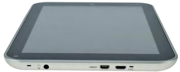
**Der Toshiba Encore verfügt über einen Micro-HDMI-Ausgang für den Anschluss eines externen Monitors, eines Beamer oder an Ihr TV-Gerät im Wohnzimmer.**
