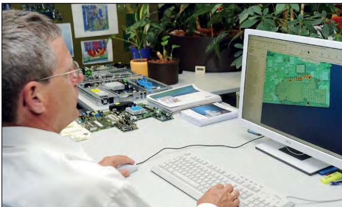
Schritt 1: Einer der ersten Schritte bei der Mainboard-Entwicklung ist die mechanische Konstruktion. Hier wird ein CAD-Modell des Boards erstellt, das in Zusammenarbeit mit dem Mainboard-Layout immer detaillierter wird.
