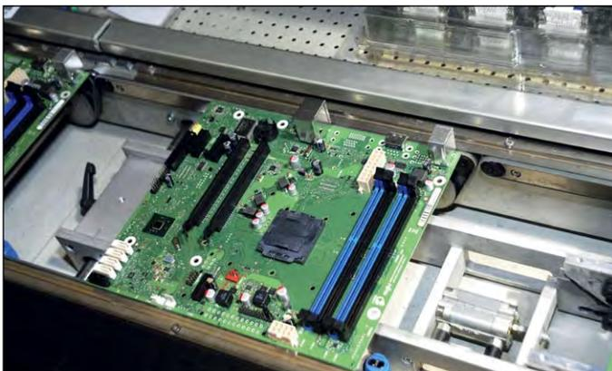
**Schritt 7:** Einige große Bauteile wie die Speichersockel, die Slots für Steckkarten und die diversen Schnittstellen werden noch von Hand bestückt, man spricht hier von Durchsteckmontage (Through-Hole Technology).
