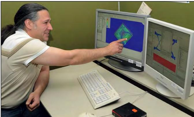
**Schritt 3:** Auf leistungsfähigen Workstations wird die Funktion der künftigen Mainboards simuliert, um schon vor dem Prototypenbau mögliche Fehler zu finden. Hier ist die EMV-Simulation eines kompletten Rechners zu sehen.
