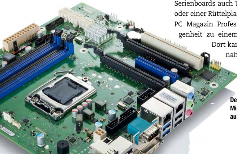
Desktop-Mainboards im Micro-ATX-Format bestehen aus etwa 1050 Komponenten.
