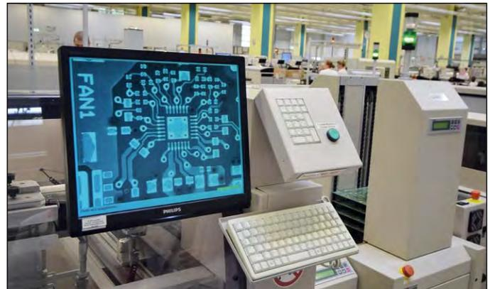
**Schritt 4:** Als erster Schritt bei der Mainboard-Fertigung wird die Lotpaste für die SMD-Bauteile mit einem Siebdruckverfahren aufgebracht. Die Lotpads werden mit einem visuellen Verfahren automatisch kontrolliert.
