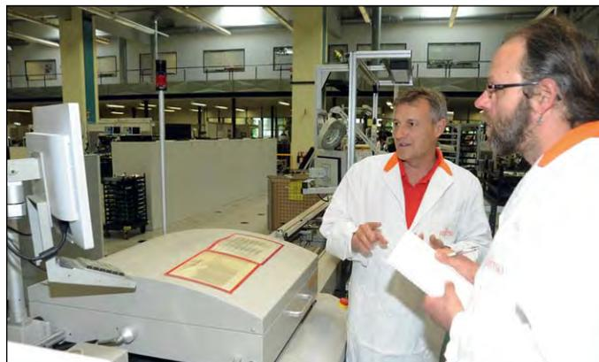
**Schritt 8:** Die fertigen Mainboards werden von einem Scanner abgelichtet und das Ergebnis mit einer Vorlage verglichen. Abweichungen wie fehlende Komponenten oder Lotbrücken werden erkannt und gleich behoben.
