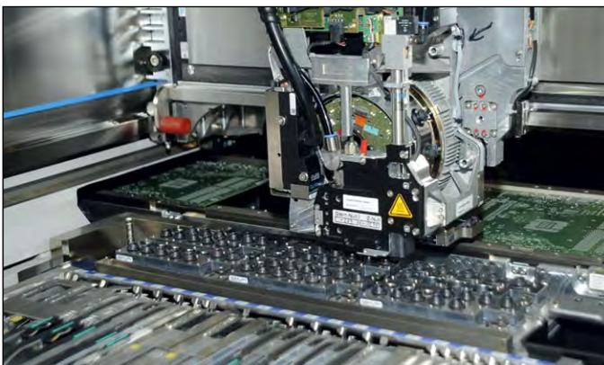
**Schritt 5:** Der SMD-Bestücker kann mit einer rotierenden Walze bis zu 80000 Bauteile pro Stunde platzieren, jedes einzelne Bauteil wird mit einer Kamera vermessen. Die Bauteile liegen auf Kunststoffbändern bereit.
