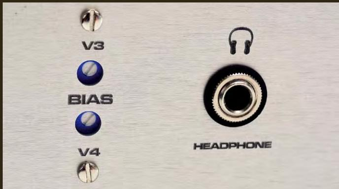
Seitlich am Chassis: ein eingebauter Kopfhörer-Amp mit Buchse sowie mühelose Ruhestromeinstellung mithilfe der Display-Anzeige.
