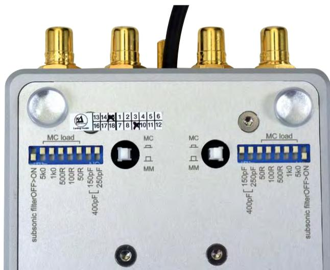
Faustregel für den Abschluss von MC-Abtastern: Innen- oder Ausgangswiderstand, multipliziert mit Faktor 5 bis 10, ergibt den Abschlusswiderstand. Beim Hören wäre dann eine „Feineinstellung“ möglich. Von unsinnigen Angaben wie „68,5 Ohm“ sollte man sich nicht ins Bockshorn jagen lassen, 20-Ohm-Stufen sind genau genug.
