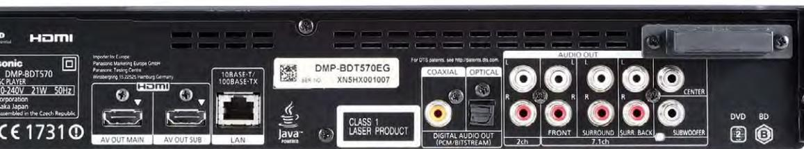
Freie Wahl: Digital lässt sich der Panasonic per HDMI oder S/P-DIF (optisch und elektrisch) mit dem Verstärker verbinden, analog über seinen 7.1-Mehrkanal-Ausgang.
