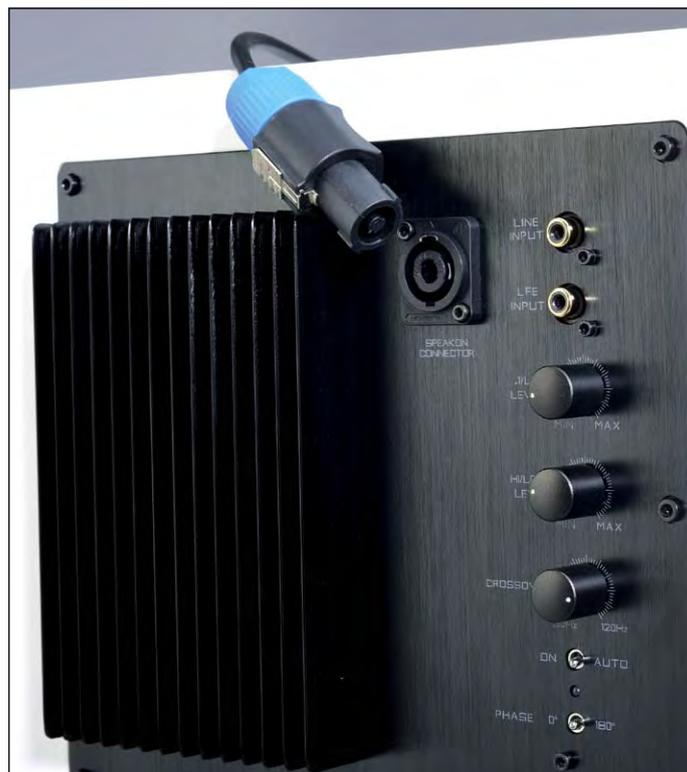
Alles vorhanden: LFE- und Line-Pegel lassen sich getrennt regeln, sodass die Lautstärke für Heimkino- und Musikbetrieb parallel optimiert werden kann. Falls man keine andere Möglichkeit hat, lassen sich über die Speakon-Buchse auch Signale aus Endverstärkern zuführen.
