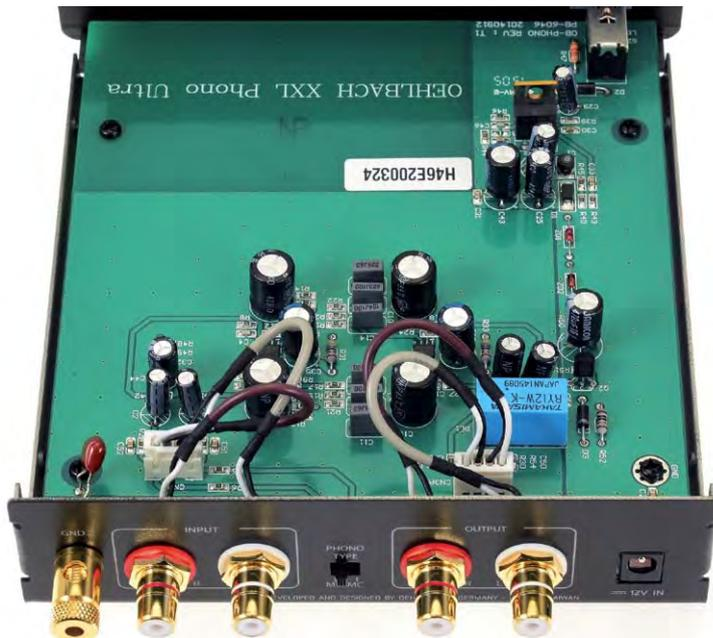
Unser Tipp, was die Erdungsklemme angeht: Im Teamwork mit einem Vor- oder Vollverstärker, der auch über eine Erdungsklemme verfügt, sollte der Nutzer das Erdkabelchen vom Plattenspieler dort und nicht am Phonoamp anschließen und den Phonoverstärker dann mit einem Extradrähtchen mit dem nachfolgenden Verstärker verbinden.
