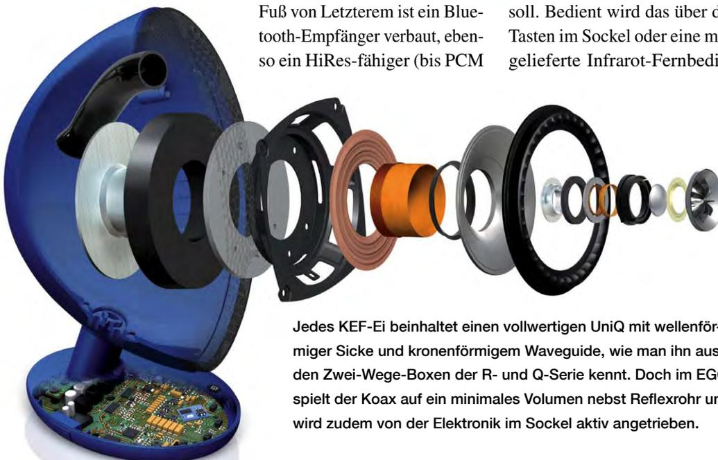
Jedes KEF-Ei beinhaltet einen vollwertigen UniQ mit wellenförmiger Sicke und kronenförmigem Waveguide, wie man ihn aus den Zwei-Wege-Boxen der R- und Q-Serie kennt. Doch im EGG spielt der Koax auf ein minimales Volumen nebst Reflexrohr und wird zudem von der Elektronik im Sockel aktiv angetrieben.
