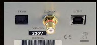
Über den koaxialen und den optischen Digitaleingang ist die Samplingfrequenz auf 96 kHz beschränkt; HD-Audio praktisch aller Formate inklusive DSD läuft via USB-Buchse zu voller Form auf.
