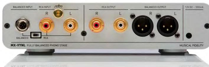
Ganz links neben dem üblichen unsymmetrischen Phonoeingang befindet sich die Buchse für den symmetrischen Anschluss von Tonabnehmern. Entsprechende Spezialkabel können von kundigen Händlern konfektioniert oder umgebaut werden. Die symmetrischen Ausgänge sind, falls möglich, bevorzugt zu benutzen.
