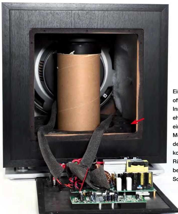
Der Lautsprecherspezialist aus dem dänischen Nøranger konstruierte für dieses Modell ein Bassreflexgehäuse, das auf eine Resonanzfrequenz von 34 Hz abgestimmt ist. Um dem an der Unterseite austretenden Rohr ausreichend Luft zu verschaffen, ruht der Subwoofer auf einem formschönen Gestell aus Aluminium – ein Merkmal, das er sich mit dem M-10 D, seinem kleineren Bruder mit 10-Zoll-Downfire-Aufbau, teilt. So schwebt er optisch förmlich über dem Boden.
