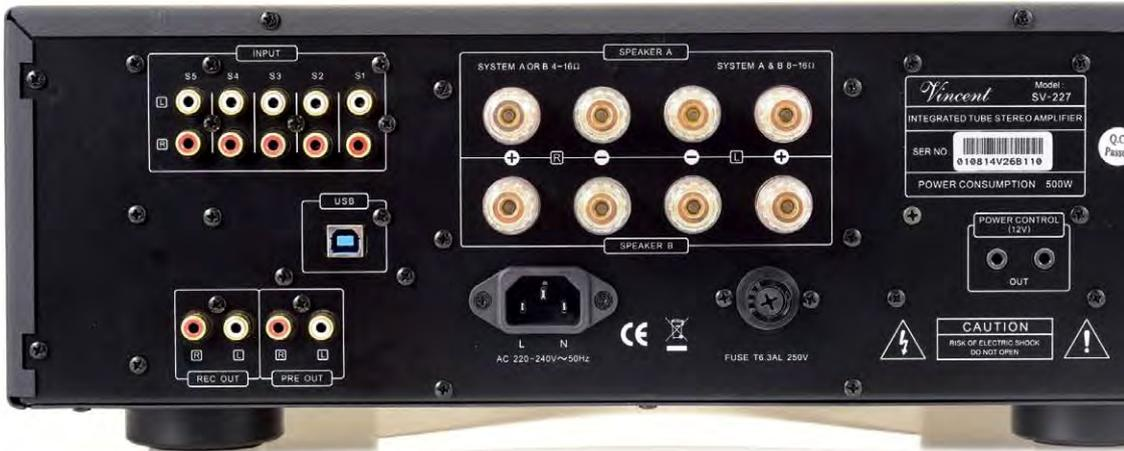
Stringent: Fünf klassische Cinch-Eingänge bietet Vincent an – dazu einen USB-Port mit eigenem D/A-Wandler. Zudem an Bord: ein Pre-Out und ein Rec-Out. Ebenso vorbildlich geraten: die Lautsprecherklemmen zum Festschrauben von Kabelschuhen sowie zum schnellen Kontakt per Bananas.
