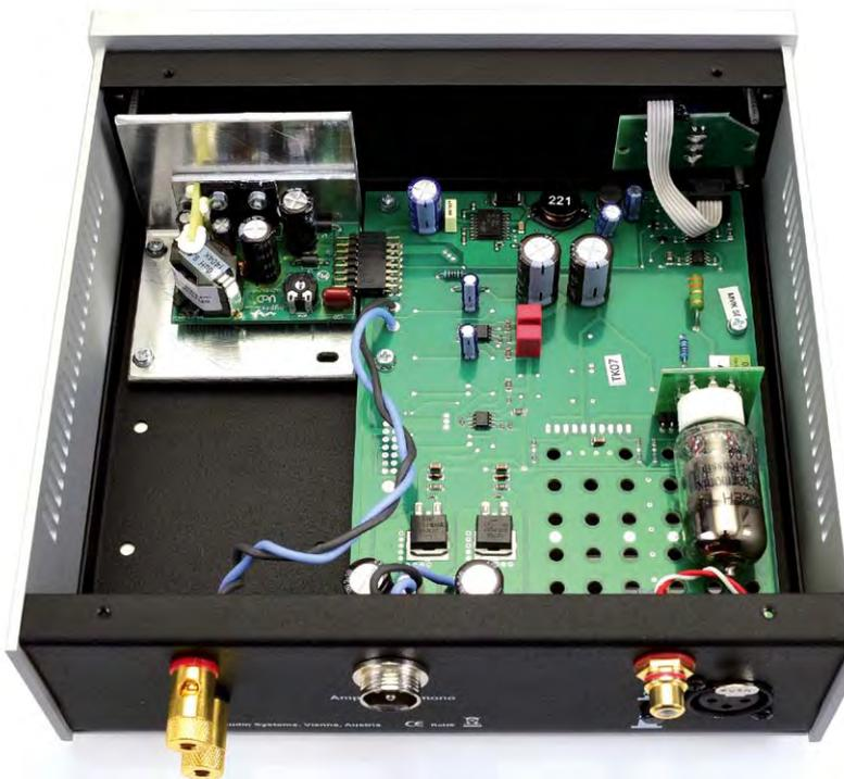
Eine Röhren-Puffervorstufe mit ECC88 kombiniert Pro-Ject in den Mono-Blöcken mit einer Class-D-Endstufe von Hypex. Das tönt stark, effektiv, großartig – wahlweise per Cinch oder XLR ankoppelbar.
