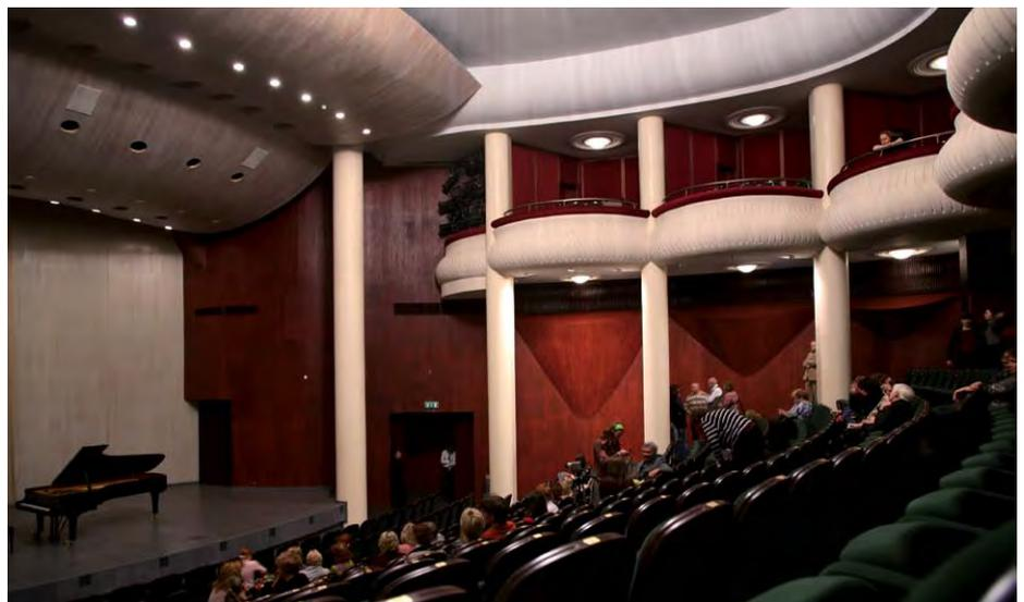
Sanfte Rundungen: In diesem Konzertsaal sorgen viele bauliche Maßnahmen für möglichst angenehme Akustik. Über der Bühne sollen „Segel“ an der Decke für geordnete Schallabstrahlung in das ansteigende Zuhörer-Parkett sorgen. Die Logen über dem Halbrund diffundieren den Indirekt-schall weiter. Parallel laufende, gerade Wände oder Begrenzungen sind kaum auszumachen.
