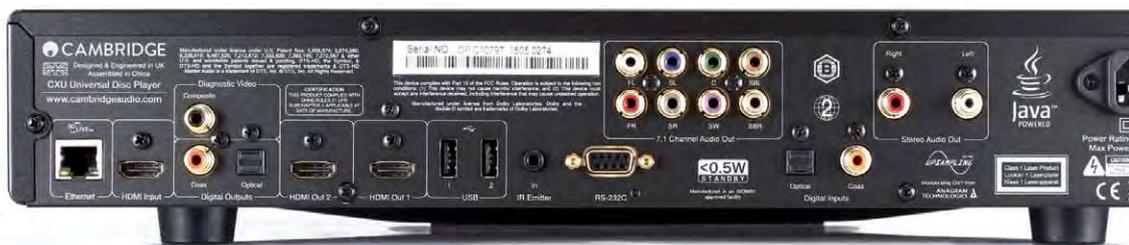
Vorstufe inklusive: Der CXU besitzt in der Lautstärke regelbare Analogausgänge für Mehrkanal- und Stereoton. Über die beiden HDMI-Inputs (einer an der Front) sowie je einen koaxialen und optischen Digitalton-Eingang nimmt er auch Video- und Audiosignale von Zuspelern entgegen.
