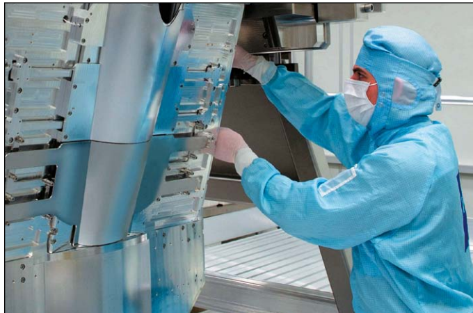
Blick auf eine EUV-Anlage bei Zeiss in Jena, die Chips mithilfe von ultravioletter Strahlung produziert (EUV-Lithografie).
