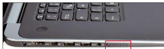
**Praktisch:** Das Dell XPS 15 zeigt auf Knopfdruck mit fünf kleinen LEDs den Akkustand an, ohne dass das Notebook gestartet werden muss.
