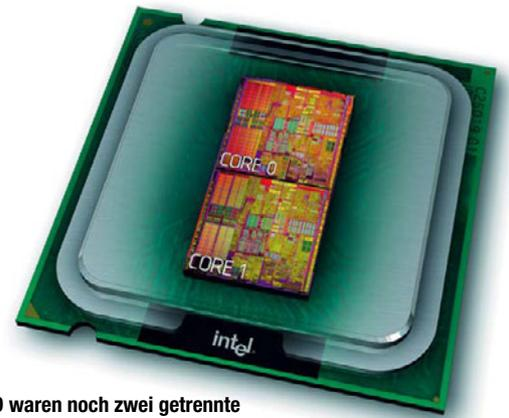
Beim Intel Pentium D waren noch zwei getrennte Cores im Prozessorgehäuse untergebracht.
