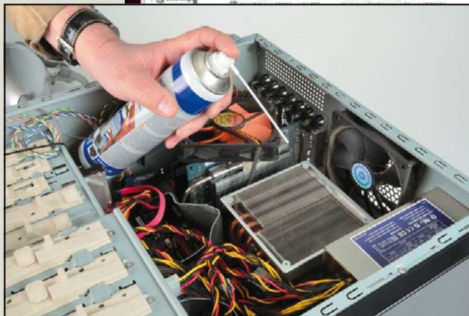
Den Staub zwischen den Rippen des Prozessorkühlers beseitigen Sie am besten mit einer Druckluftdose.
