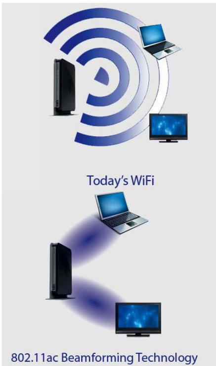
Mit *Beamforming* suchen ac-Router die bestmögliche Verbindung zum Funkpartner. Quelle: Netgear
