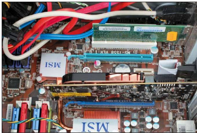
**Mainboard-Chipsätze mit Core-2-Duo-Prozessoren unterstützen grundsätzlich bereits PCI-Express 1.1 oder mehr. Damit sind sie zu modernen Grafikkarten mit PCI-Express 3.0 kompatibel.**
