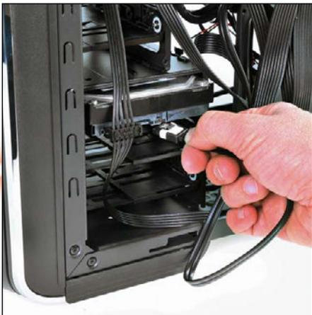
SATA-Platten bieten eine höhere Kapazität und sind gleichzeitig günstiger, als noch verfügbare Parallel-ATA-Laufwerke.
