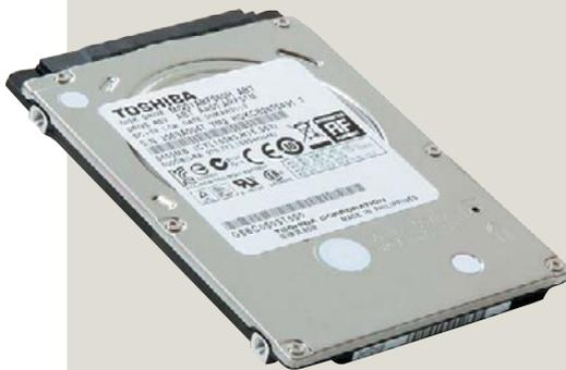
Die Hybrid-HDD wird von einer Mini-SSD beschleunigt. Das Äußere unterscheidet sich kaum.
