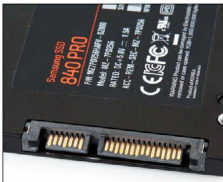
Für SSDs sind die SATA-Controller in älteren PC's nicht schnell genug. Abhilfe schafft eine zusätzlicher PCIe-Karte mit einem 600-MBit-Controller.
