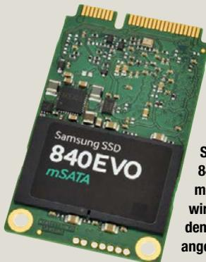
Samsung SSD 840 EVO: Die mini-SATA-SSD wird direkt auf dem Mainboard angesteckt.
