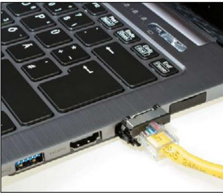
Fujitsu hat beim Lifebook U904 eine clevere ausziehbare Klappbuchse für den Ethernet-Anschluss eingebaut. Es kommt ohne Adapterstecker aus.
