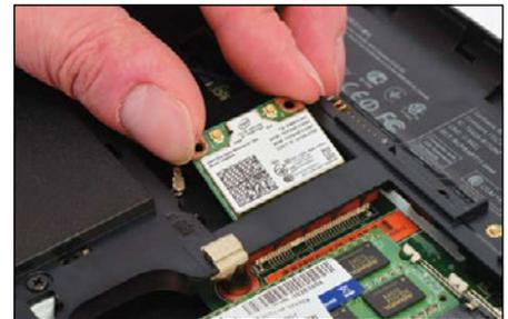
**Existiert nur ein Antennenkabel, dann stecken Sie es an der Buchse mit der Markierung „1“ ein. Bei zwei Kabeln folgen Sie dem Vorbild der alten Karte.**
