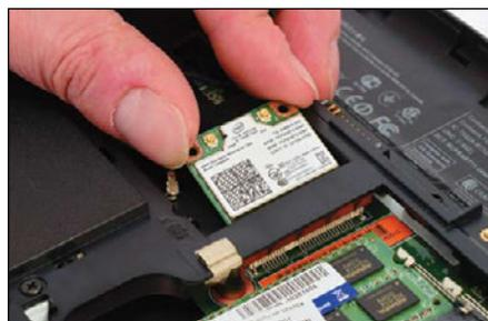
**Schieben Sie die neue WLAN-Karte bis zum Anschlag in den Mini-PCIe-Sockel, drücken sie herunter und fixieren Sie mit der Halteschraube.**
