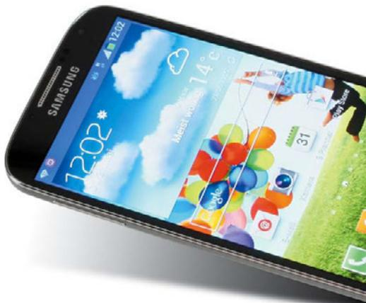
Samsung hat im Galaxy S4 mit Air Gesture eine einfache Gestenerkennung mittels der Frontkamera eingebaut.
