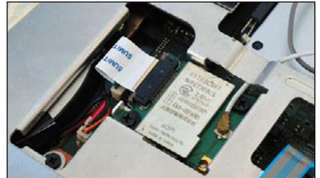
Bei vielen älteren Notebooks ist eine separate Bluetooth-Karte mit USB-Anschluss eingebaut.
