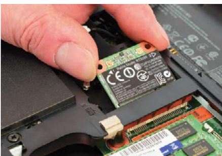
**Lösen Sie die Befestigungsschrauben und die Antennen, bevor Sie die alte WLAN-Karte ausbauen.**
