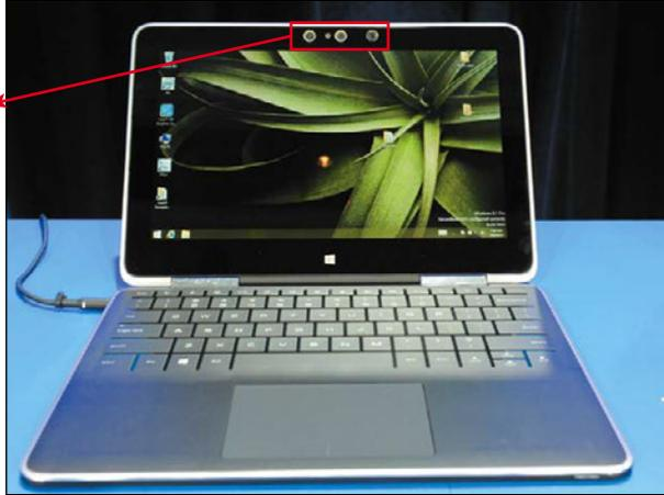
Intel präsentierte auf der CES als Prototyp ein Dell-Notebook mit integrierter RealSense 3D Kamera. Für die Tiefeninformation wird eine Infrarot-Kamera genutzt.
