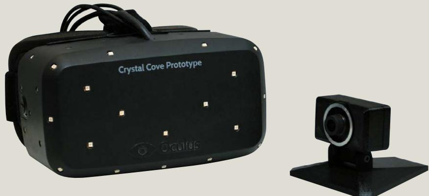
Eine zusätzliche Kamera erfasst bei der Oculus Rift Crystal Cove die Kopfposition des Trägers.
