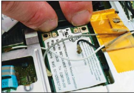
Ältere WLAN-Karten im Mini-PCIe-Format mit voller Höhe sind durch kleine Riegel fixiert.
