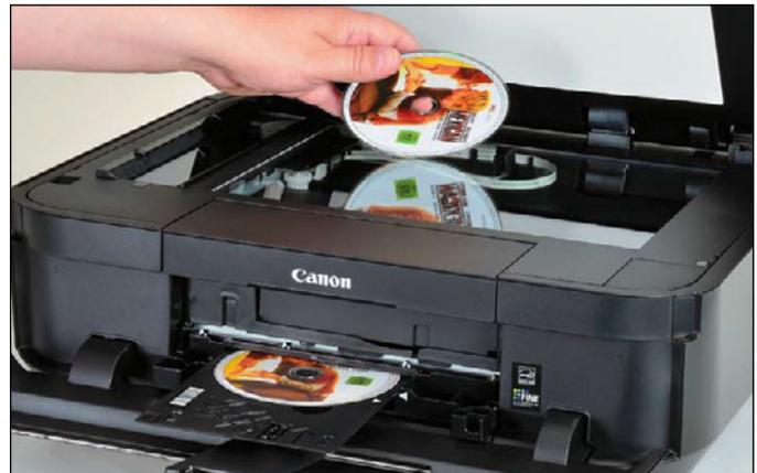
Ideal gelöst ist das Kopieren eines Original-CD-Labels beim Canon durch die direkte Abtastung über das Flachbett auf den bedruckbaren Rohling.
