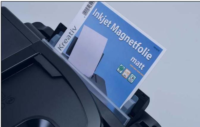
Für dicke Medien und Briefumschläge bietet der Epson einen zweiten Einzug an der Rückseite und ermöglicht so einen Papierdurchlauf ohne Umlenkung.
