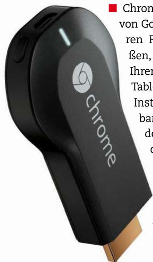
■ Chromecast ist ein Stick von Google, den Sie an Ihren Fernseher anschließen, um Inhalte von Ihrem Smartphone oder Tablet darzustellen. Die Installation ist denkbar einfach: Stick in den HDMI-Eingang des TVs einstecken, App auf dem Mobilgerät installieren und über das WLAN eine Verbindung herstellen.
