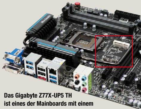
**Das Gigabyte Z77X-UP5 TH ist eines der Mainboards mit einem eigenen Slot für mSATA-SSDs als Cache-Laufwerk.**
