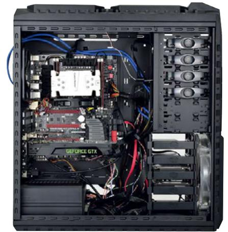
Unser Testsystem mit Intel Core i7-3930K, Asus-X79-Mainboard, 32 GByte RAM und einer GeForce-GTX-680-Grafikkarte von PNY.
