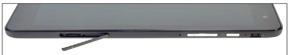
Der Steckplatz für Micro-SD-Karten ist beim Dell Venue 8 Pro durch eine Kunststoffabdeckung geschützt. Mit einer Dicke von 9 Millimetern ist das Dell neben dem Lenovo das flachste Tablet im Testfeld.
