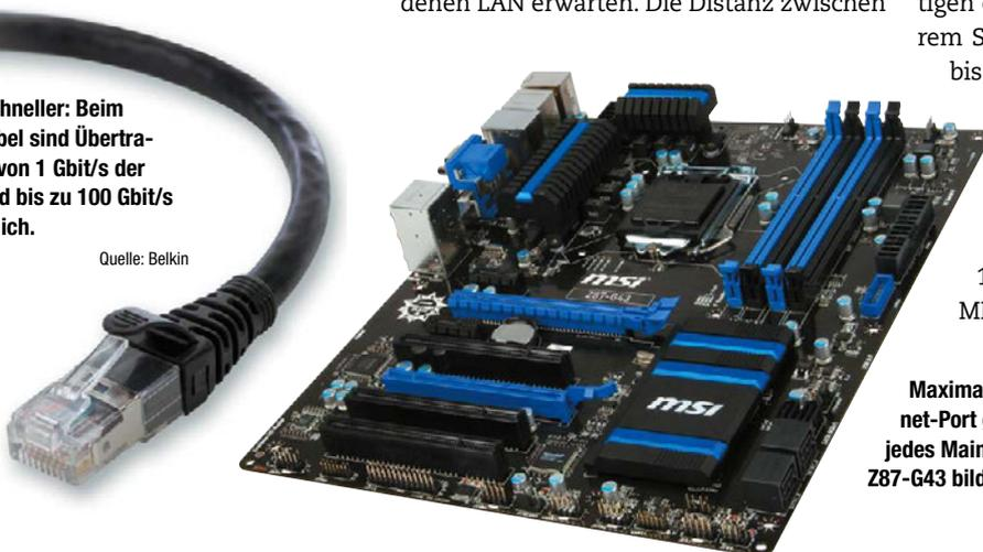
**Maximales LAN-Tempo ab Werk: Ein Gigabit-Ethernet-Port gehört inzwischen zur Standardausstattung jedes Mainboards. Auch das Sockel-1150-Modell MSI Z87-G43 bildet da keine Ausnahme.** Quelle: MSI
