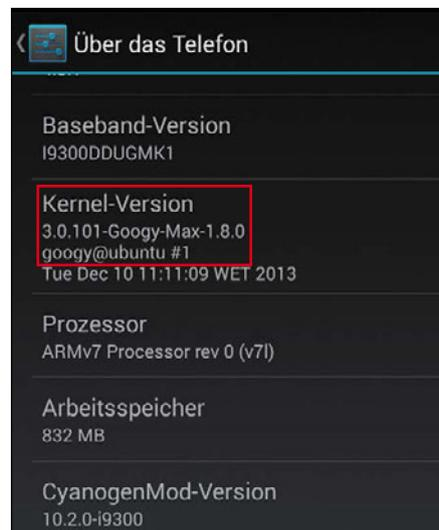
**Alternativ-Kernel sind für bestimmte Geräte konzipiert und setzen auch eine spezielle Android-Version voraus. (Hier: Googy-Max-Kernel)**
