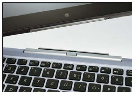
Das Keyboard verbindet sich via Bluetooth mit dem Tablet, es funktioniert daher auch abgedockt.
