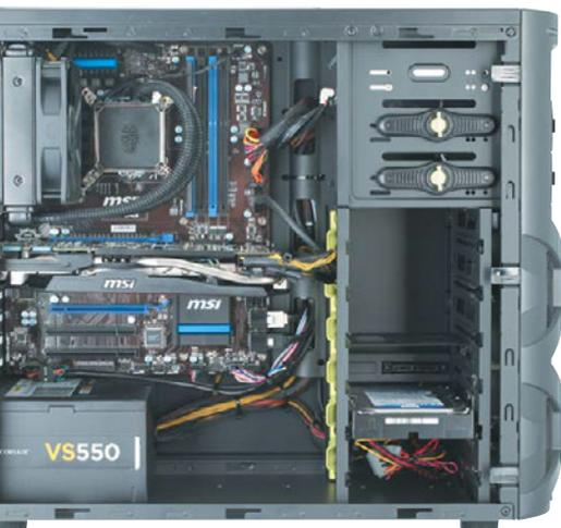
Auf dem übertakteten Core i5-4670K sorgt eine Seidon-120-Wasserkühlung von Cooler Master dafür, dass es der CPU nicht zu warm ums Herz wird.
