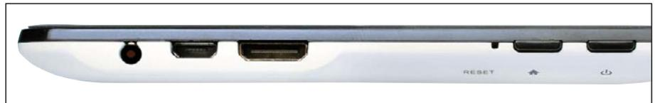
Das flache Kunststoffgehäuse sorgt beim Colorfly E781 Q1 für ein geringes Gewicht. Aber es ist nicht besonders verwindungssteif und wird zudem bei der Nutzung des Tablets recht warm.
