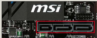
Die SATA-Express-Schnittstelle mit zwei PCIe-Lanes ist auch kompatibel zu SATA-Drives.
