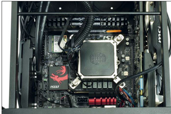
Die Pumpe der Cooler-Master-Wasserkühlung bildet eine Einheit mit dem Kühlkörper auf dem Prozessor.
