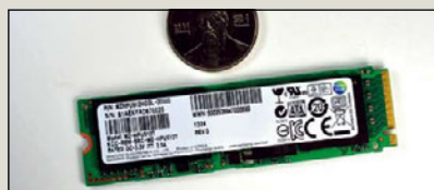
PCI-Express-SSDs mit M.2-Schnittstelle benötigen in Mobilrechnern nur wenig Platz.
