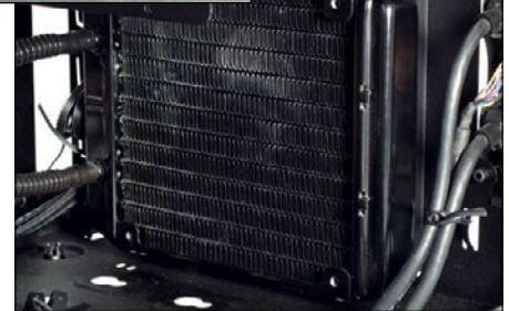
Den Radiator für die Wärmeabfuhr haben wir hinter dem frontalen Gehäuselüfter untergebracht.
