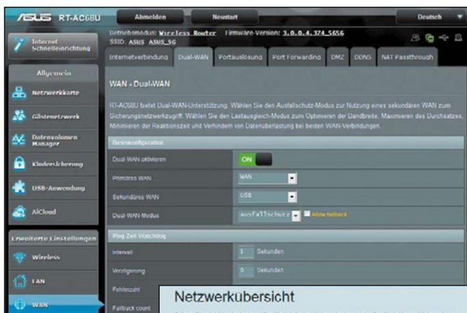
**Der Asus RT-AC68U besitzt als einziger AC1900-Router die Option, einen zweiten WAN-Zugang zum Lastenausgleich oder als Ausfallschutz einzurichten.**
