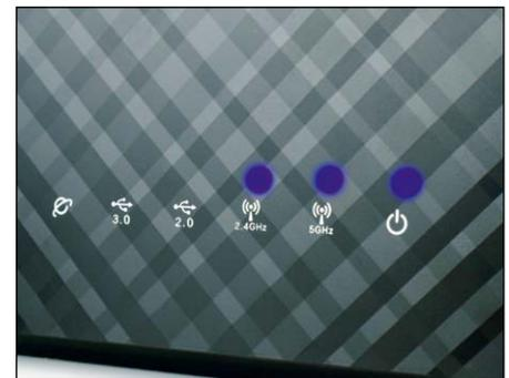
Die aktiven LEDs am Asus Router zeigen an, welches Frequenzband zur Verfügung steht.
