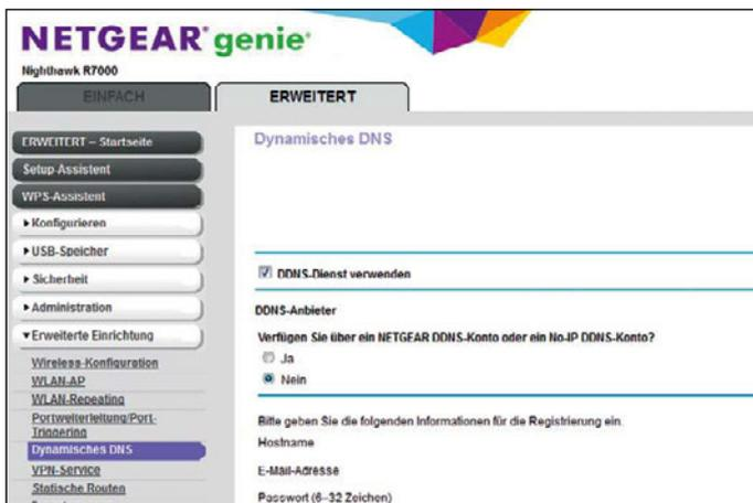
**Alle Router sind in der Regel mit einem DDNS-Client ausgestattet. Dieser Netgear-Router bietet sogar ein eigenes DDNS-Konto zusammen mit dem Anbieter No-IP an.**
