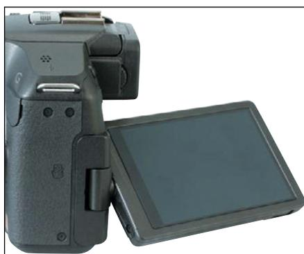
**Mit einem Drehgelenk ist das Touch-Display der Panasonic G6 deutlich flexibler als das der Sony, deren Bildschirm lediglich über ein Klappscharnier verfügt. Eine Touchfunktion fehlt der Sony ebenfalls.**
