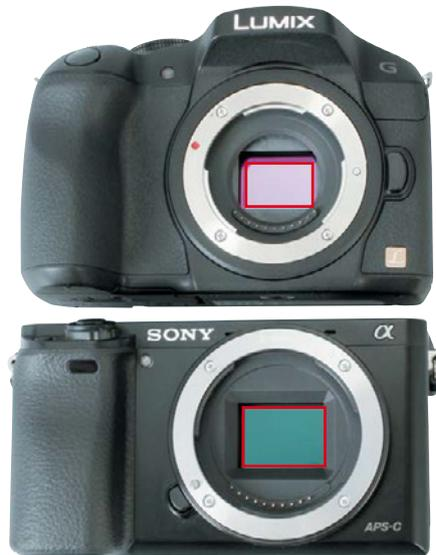
**Sensorgößen im Vergleich: Die Lumix DMC-G6 hat einen Four-Thirds-Sensor, der kleiner ist als der APS-C-Format-Sensor in der Sony Alpha 6000.**
