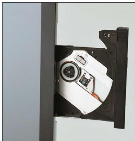
Toshiba hat einen Blu-ray-Brenner gut zugänglich direkt hinter das Display eingebaut.
