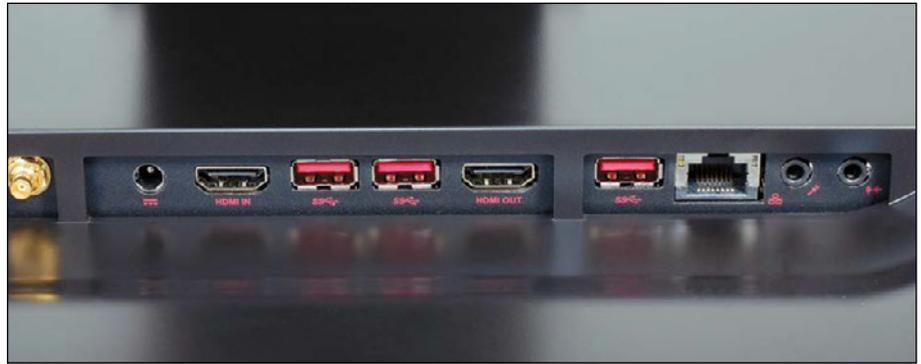
Der MSI AG240 bietet auf der Rückseite des Gehäuses eine Vielzahl von Anschlüssen. Gut zugänglich sind sie aber nur, wenn man das Gerät nach vorne umlegt. Das ist nicht sonderlich praktisch.
