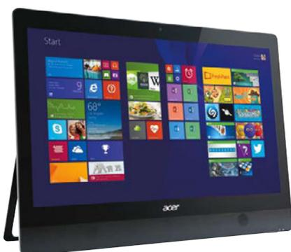
■ Mit dem Aspire U5-620 hat Acer jetzt einen stylischen All-in-One-Computer vorgestellt, der über ein 23 Zoll (58,42 cm) Full HD Multitouch-Display verfügt. Das Gerät lässt sich fast beliebig ausrichten und auch flach als Tablet nutzen. Im Inneren arbeiten Intel-Prozessoren der vierten Generation und eine NVIDIA-GeForce-GTX-Grafiklösung. Ferner sind ein Hybrid-Laufwerk mit bis zu 1 TByte Kapazität und 8 GB RAM vorhanden. WLAN 802.11ac garantiert schnelle Datenübertragung.
