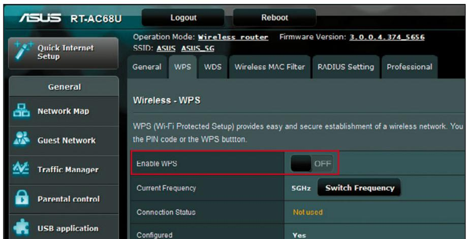
In diesem Asus-Router lässt sich WPS deaktivieren und zudem an ein bestimmtes Frequenzband koppeln – und funktioniert dann im anderen Frequenzband nicht.
