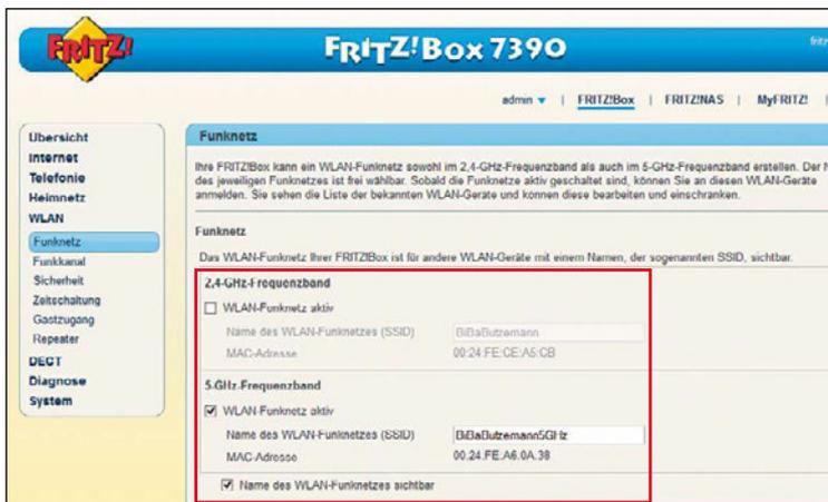
Bei Dualband- Routern lässt sich das WLAN in den beiden Frequenzbändern getrennt an- und ausschalten.
