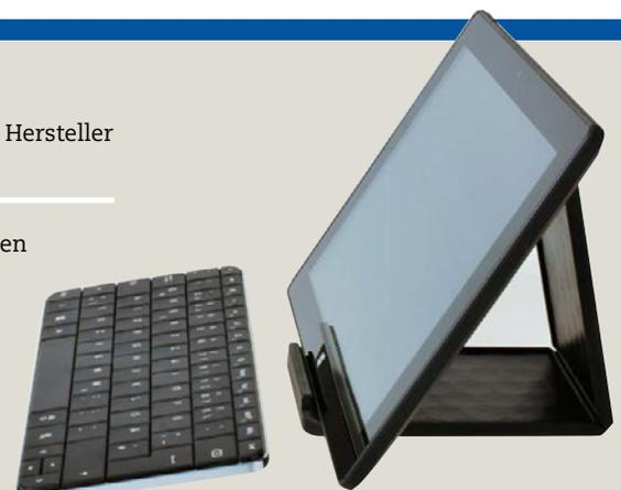
**Beim Microsoft Wedge Keyboard ist die Tastaturabdeckung gleichzeitig ein Tablet-Standfuß.**
