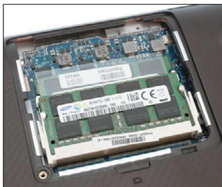
Das Gerät ist mit satten 16 GByte RAM bestückt, so geht der Speicher auch bei 4K-Photos nicht aus.
