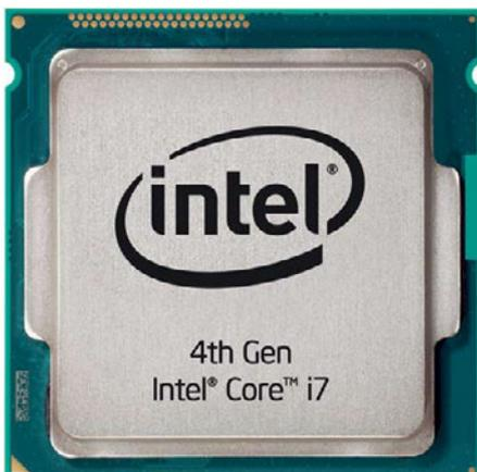
**Flott:** Der Core-i7 auf Haswell-Basis arbeitet mit vier Kernen und bis zu 4,4 GHz im Turbo-Boost.
