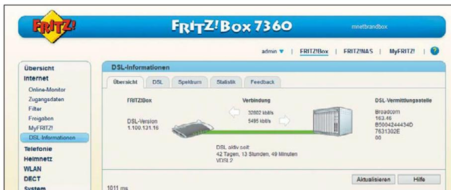
Ist die Linie grün wie auf dem Bild, steht die DSL-Verbindung zwischen DSLAM und DSL-Modem. Eine rote Linie würde auf eine Unterbrechung hinweisen.
