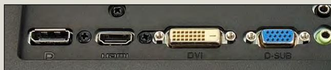
Die üblichen Anschlüsse eines Monitors sind DisplayPort (DP), HDMI, DVI und VGA (v.l.).
