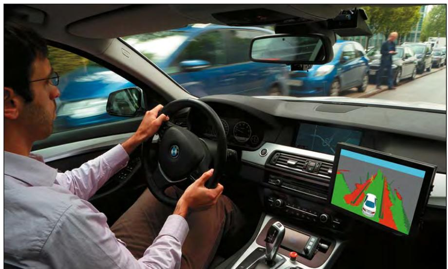
Assistenzsysteme scannen unter anderem mit Laser gesteuerten Sensoren die Umgebung des Autos ab. Reagiert der Fahrer nicht schnell genug auf Gefahren, greift der Assistent ins Fahrgeschehen ein.
