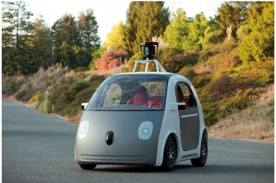
Der Prototyp von Googles selbst fahrendem Auto kommt ohne Steuer und Gaspedal aus. Dafür steckt das Google-Mobil voller Kameras – inklusive einer 360° Rundumkamera und Sensoren.
