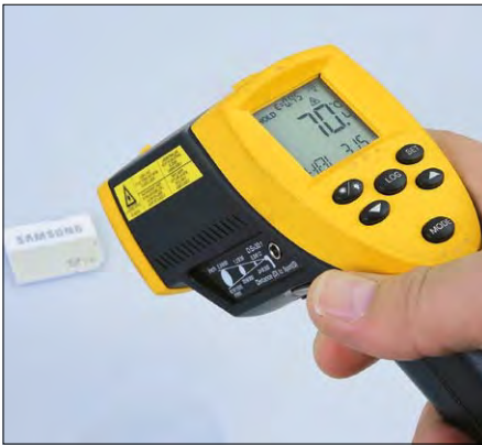
Mit dem Raytek Raynger ST messen wir die Temperatur der Speicherkarte nach der Fön-Behandlung.
