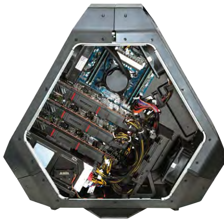
Drei Radeon R9 290x sorgen für enorme 3D-Power. Die auf 3,9 GHz übertaktete CPU ist wassergekühlt.
