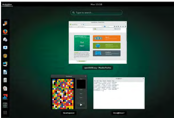
Die Activities-Übersicht in GNOME blendet eine Leiste ein und platziert alle Fenster nebeneinander (hier openSUSE).
