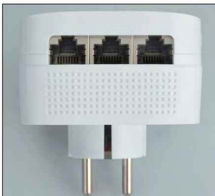
TP-Links TL-PA8030P ist auf der Geräteunterseite mit drei GBit-LAN-Ports ausgestattet.
