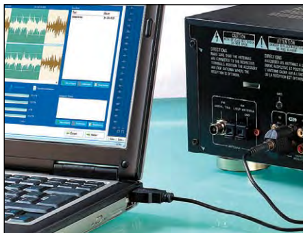
Dieses Adapterkabel sendet das analoge Signal vom Verstärker gleich digital an das Notebook.
