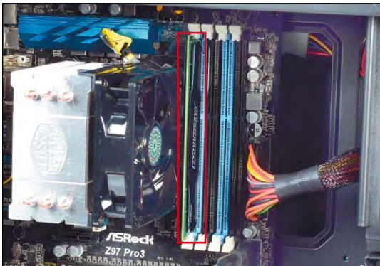
Nur ein Speicherriegel in einem PC mit Intel-Core-CPU kostet Leistung. Denn dann liegt der zweite Speicherkanal brach.
