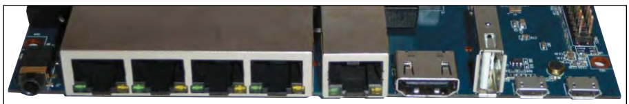
Die Erstkonfiguration des Routers ist einfach, denn das Board verfügt über einen HDMI-Anschluss für den Monitor und eine USB-Buchse für eine Tastatur.
