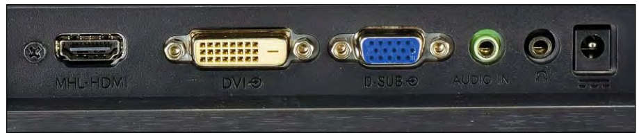
Bild und Ton vom Mobilgerät können dank MHL-HDMI (l.) an den Philips-Monitor übertragen werden.
