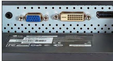
Der LG 27MB65PY bietet die Schnittstellen VGA, HDMI und DisplayPort (v. l.) – HDMI fehlt jedoch.
