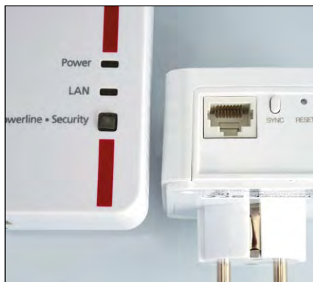
Bei AVM (li.) ist der Pairing-Knopf zugleich die PLC-LED, Trendnet (re.) bietet eine separate Reset-Taste.
