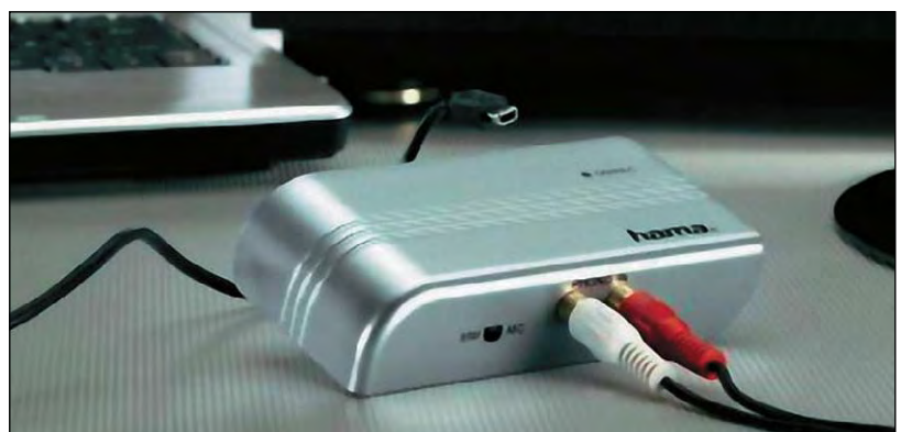
Phono-Vorverstärker verstärken die Signale von Plattenspielern ohne eigenen Verstärker.
