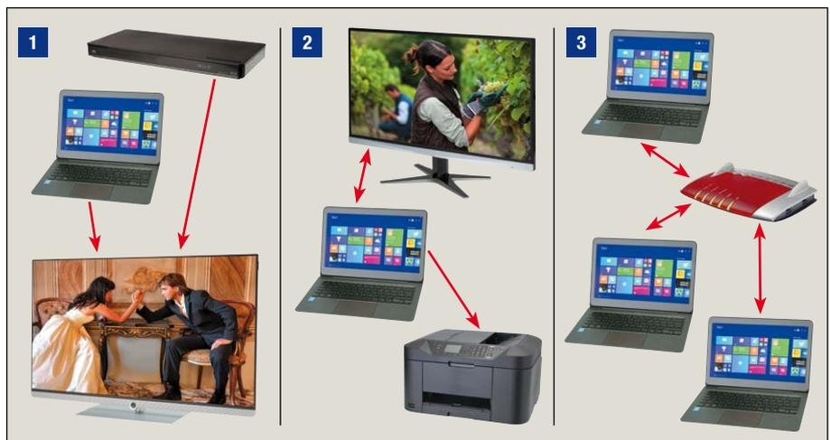
Über den Funkstandard WiGig respektive 802.11ad lassen sich verschiedene Benutzermodelle realisieren: **1** Drahtlose AV-Übertragungen als HDMI- oder DP-Ersatz bis 4K bei 60 Hz. **2** Drahtlose Peripherie, zum Beispiel als USB-Kabelersatz oder PCIe via Funk. **3** Superschnelle WLAN-Verbindung für den Nahbereich. *Session transfer* ermöglicht das nahtlose Umschalten zwischen den WLAN-Bändern.
