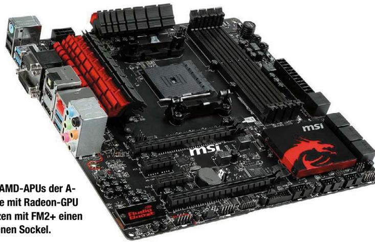
Die AMD-APUs der A-Serie mit Radeon-GPU nutzen mit FM2+ einen eigenen Sockel.
