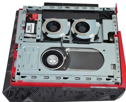
Die GeForce GTX 980 in der unteren Hälfte des Asus-PCs wird durch ein eigenes Netzteil versorgt.
