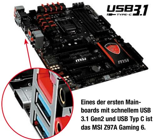
Eines der ersten Mainboards mit schnellem USB 3.1 Gen2 und USB Typ C ist das MSI Z97A Gaming 6.
