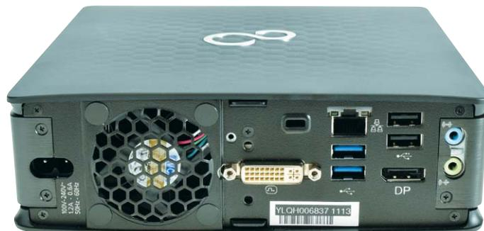
**Beim Fujitsu Esprimo Q920 ist das Netzteil im Gehäuse integriert. Es ist mit auf das Mainboard gelötet und kann so direkt geregelt werden.**
